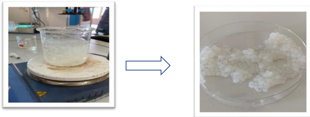
Figure II.1 : Préparation des billes de chitosane (CS).
