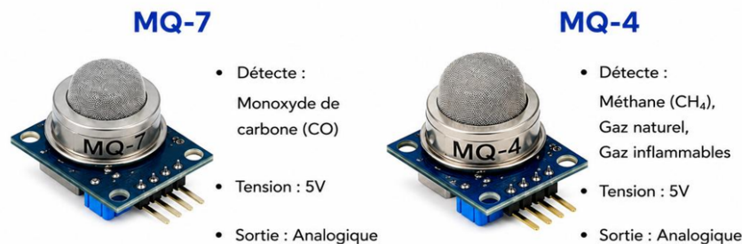
FIGURE 2.3 – Les capteurs utilisés dans le système GGH
