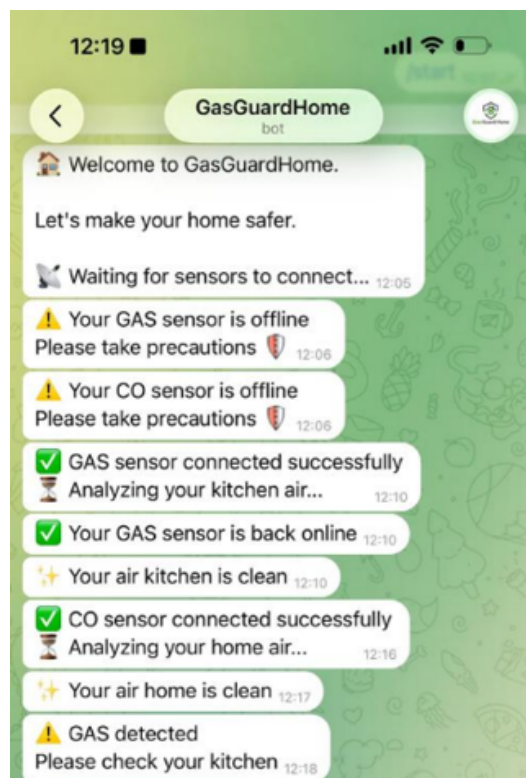
FIGURE 3.9 – Notifications d'alerte de niveau 1 pour le gaz et le monoxyde de carbone
