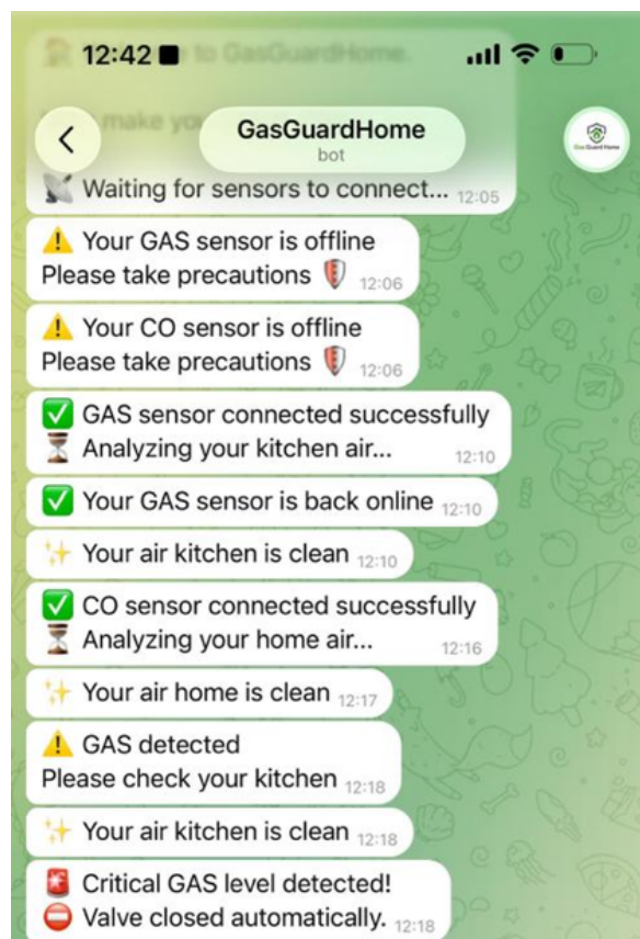
FIGURE 3.10 – Notifications d'alerte critique (niveau 2) et fermeture automatique de l'électrovanne
