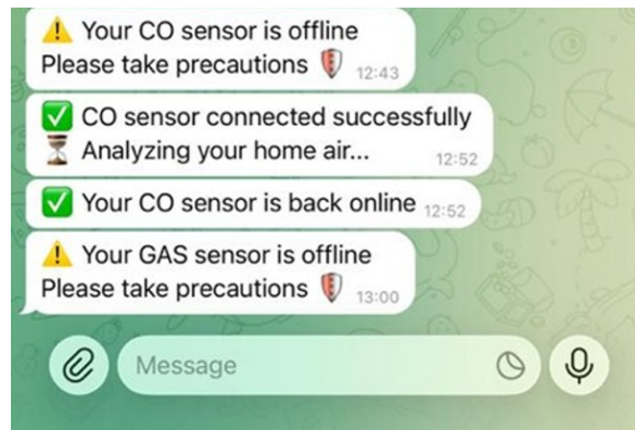
FIGURE 3.11 – Notifications de déconnexion et de reconnexion des capteurs
