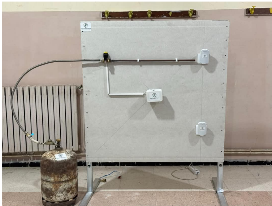
FIGURE 3.7 – Exemple de test du capteur MQ-4 à l'aide d'une source de gaz butane
