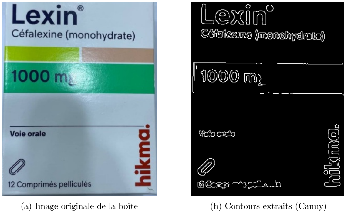
FIGURE 1.3 – Extraction des contours à l'aide de l'algorithme de Canny
