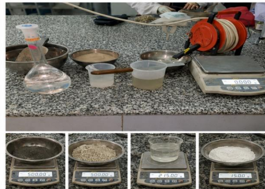
4. Malaxage final : ajout progressif de la solution activante et des fibres de chanvre – contrôle des quantités
