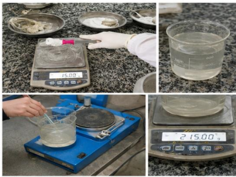
3. Préparation de la solution activante : pesée des solides, dissolution dans l'eau et vérification de la masse totale
