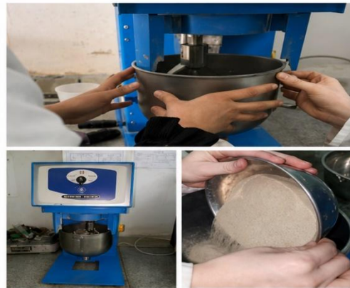
2. Malaxage à sec : mélange du laitier avec la perlite dans le malaxeur
