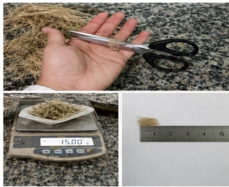
1. Préparation des fibres de chanvre : pesée et découpe à la longueur souhaitée (~10 mm)
