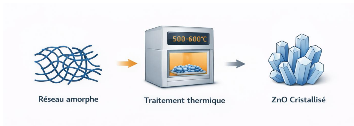
Figure 11 : Schéma du traitement thermique et de la cristallisation d'une hétérostructure. [11]
