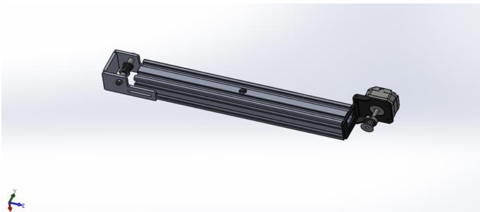
Figure III.2 : L'axe X avec moteur Nema 17
