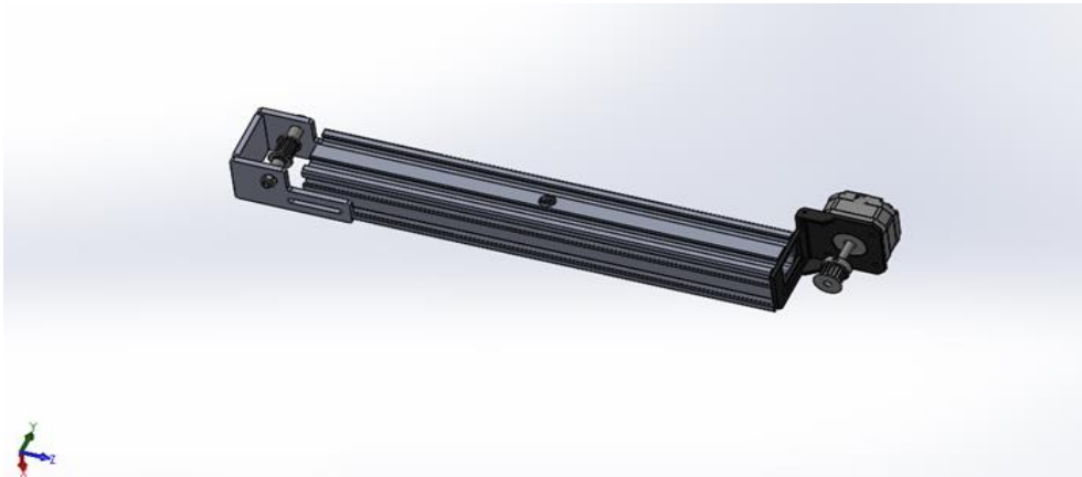
Figure III.3 : L'axe Y avec moteur Nema 17
