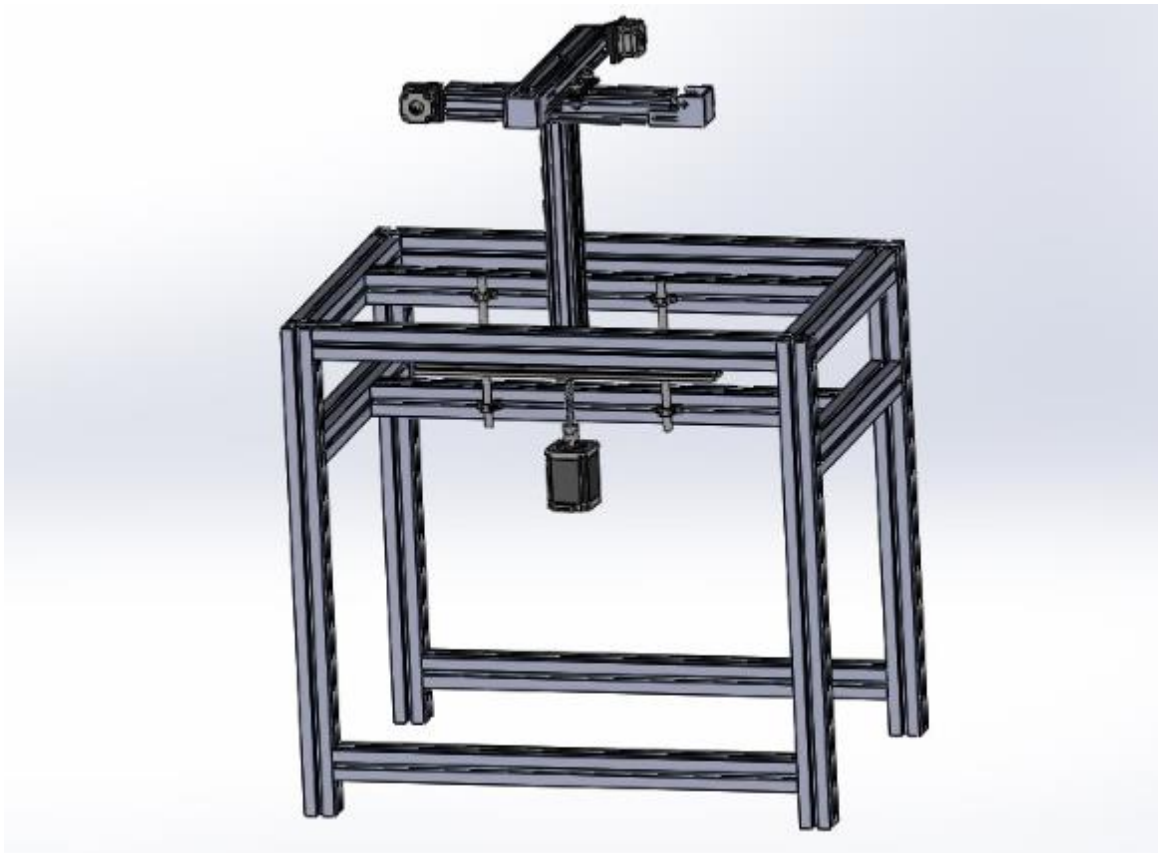
Figure III.6 : Assemblage des différentes parties (table + trois axes).
