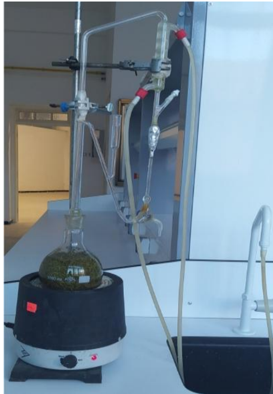
Figure 4 : Dispositif d'extraction par hydrodistillation de l'ortie et du romarin (Photo originale, 2025)
