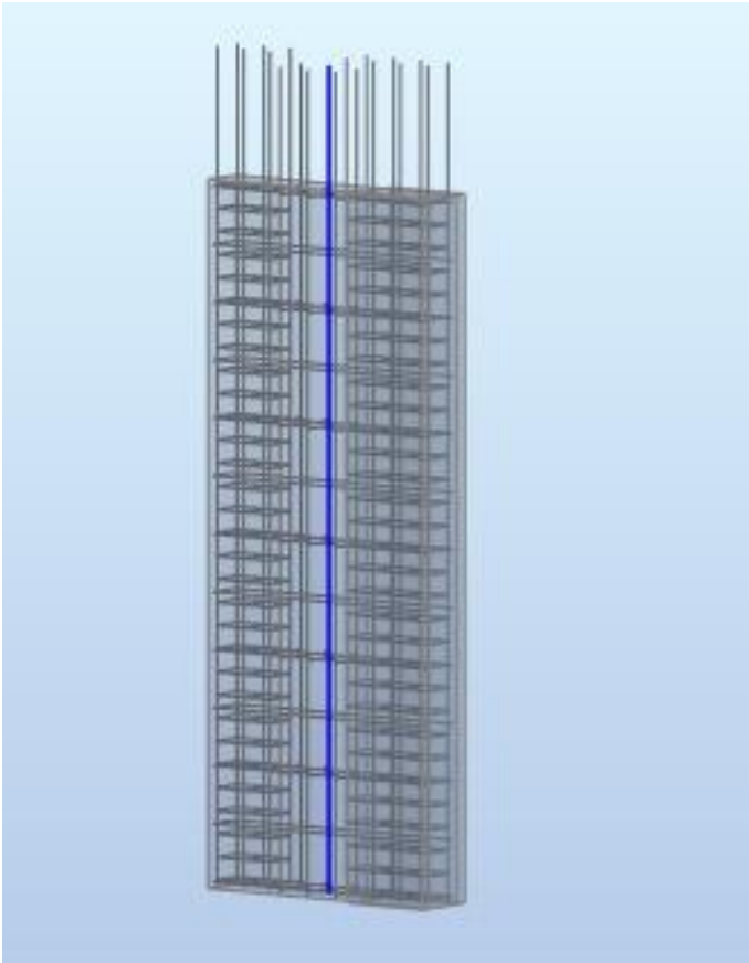
Figure V-30 : schéma de ferrailage de voile
