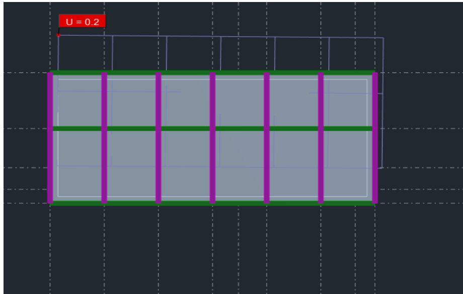
Figure IV-3: (mode2) translation suivant l'axe (Y-Y).
