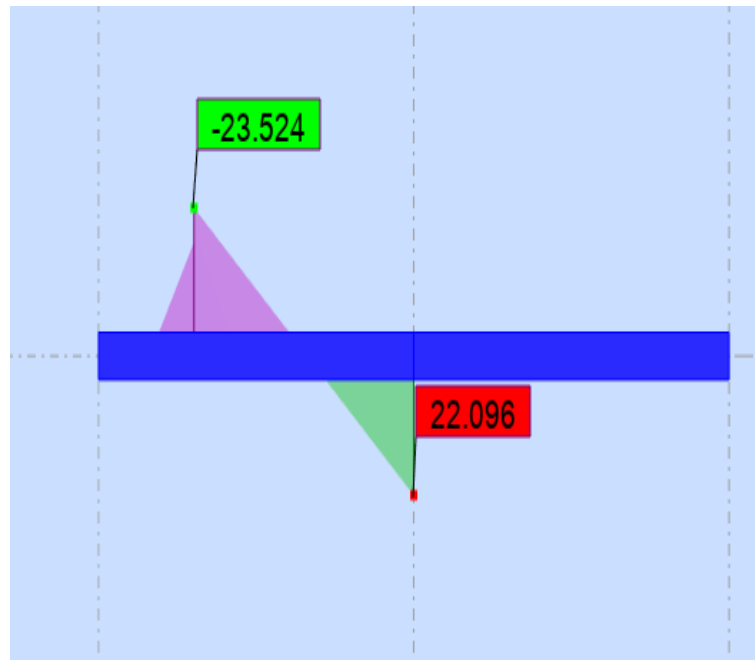
Figure V-16 : moments max a ELU des poutres secondaires.
