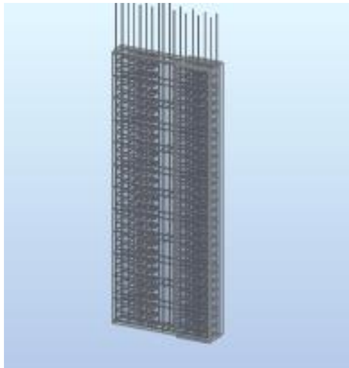
Figure V-61 : schéma de ferraillage de voile
