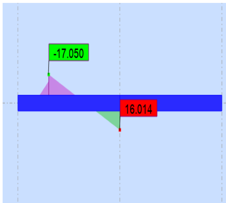
Figure V-17 : moments max a ELS des poutres secondaires.
