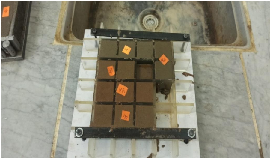
Figure 18 : Remplissage des moules
