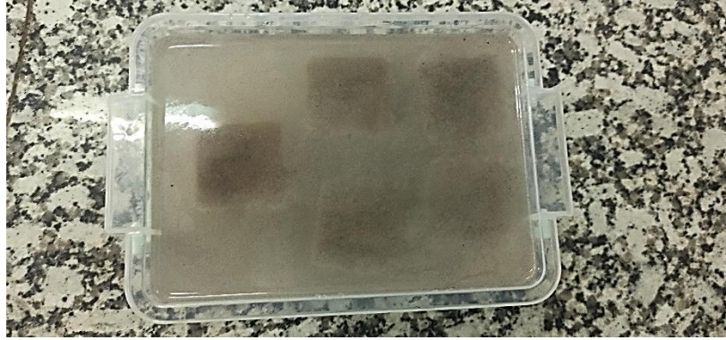
Figure 23 : la durabilité des géopolymères à base de laitier soumis à une attaque sulfurique
