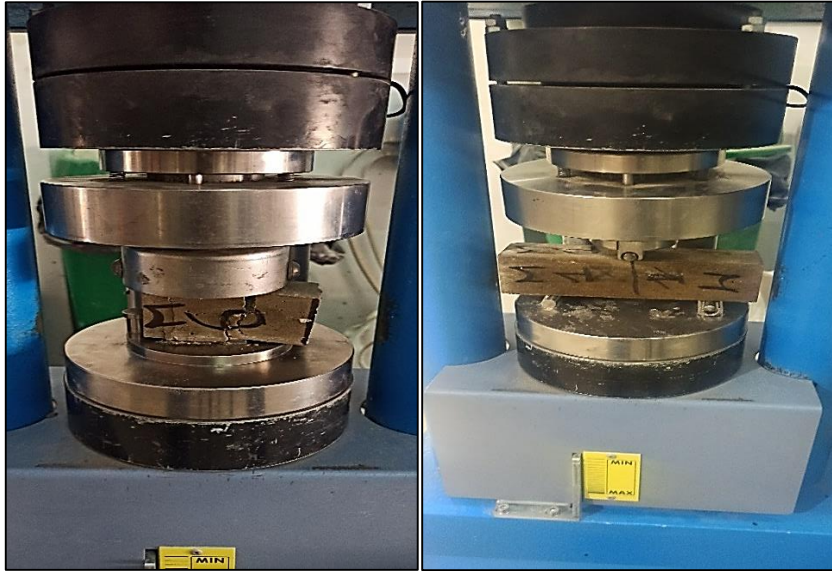
Figure 22 : Essai de la résistance à la compression et la flexion
