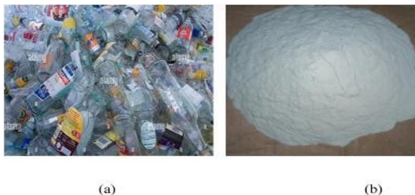
Figure 5 : (a) les verres usagés tels que reçus (b) la poudre de verre recyclée
