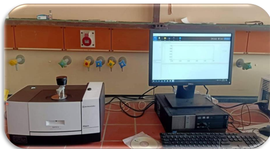
Figure II.8 : Spectrophotomètre FTIR utilisé pour la caractérisation des échantillons (FTIR Q-ATR.S)
