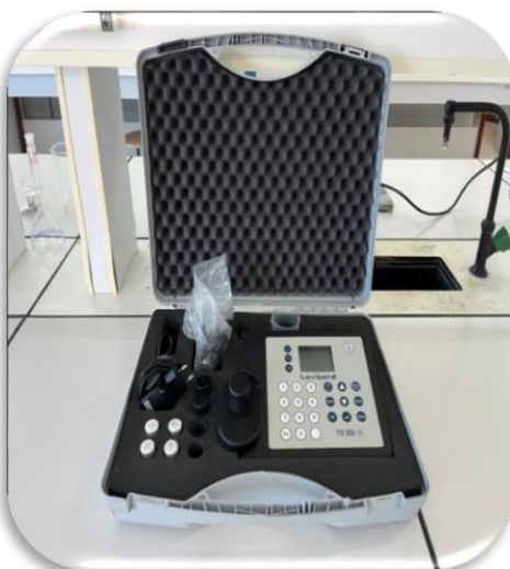
Figure II.10 : Turbidimètre utilisé pour la mesure de la turbidité
