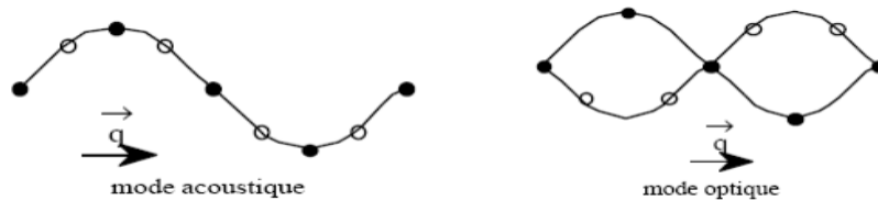
Figure I.11: Vibrations à une dimension transverses selon les branches acoustiques et optiques.[23]
