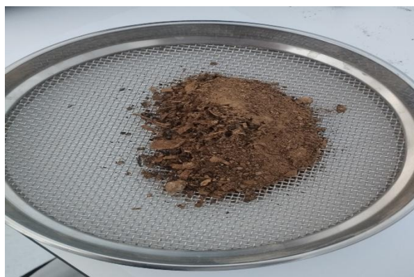
Figure 6. Tamisage des échantillons illustrant la matière organique grossière (Yahiouche et Choutri, 2025)
