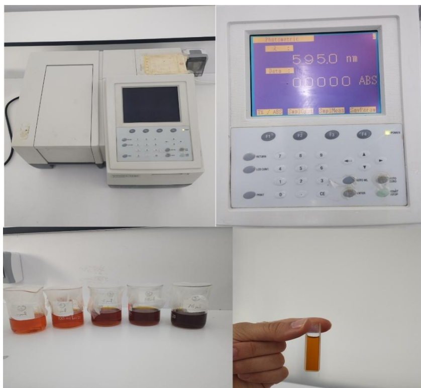
Figure 7. Quelques photos prises lors de l'application de la méthode de Walkley Black (Yahiouche et Choutri, 2025)
