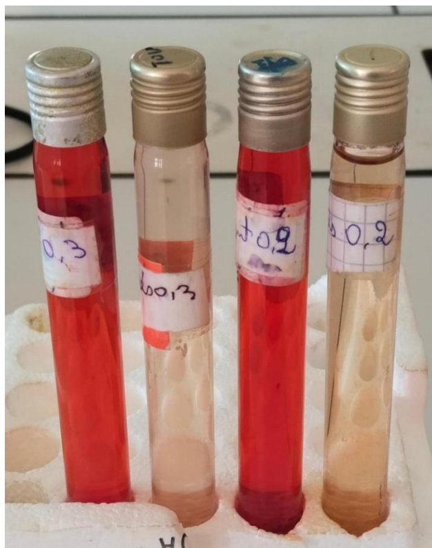
Figure III. 8: effet de l'intensité du courant sur traitement par électrocoagulation
