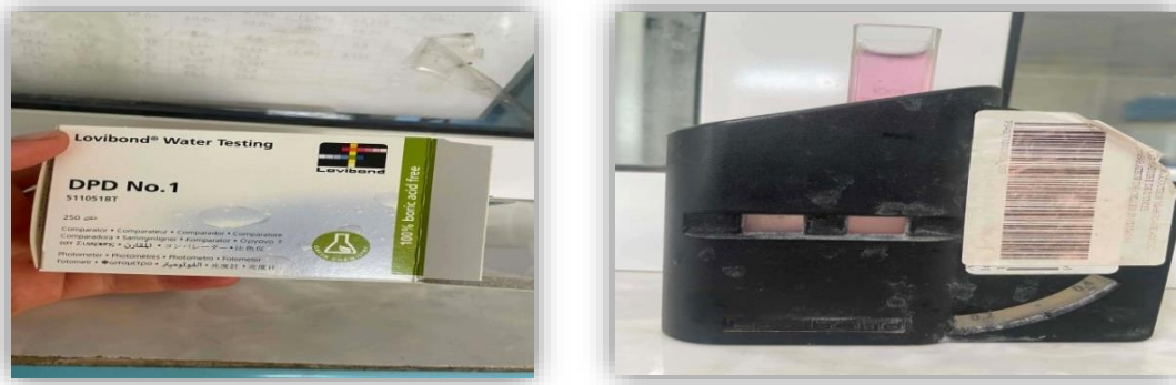
Figure III.10 : Mesure de chlore résiduel.
