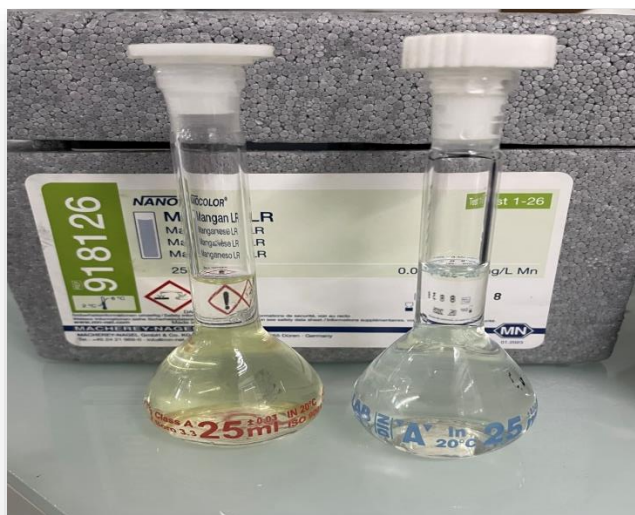
Figure III.19 : Dosage du manganèse.
