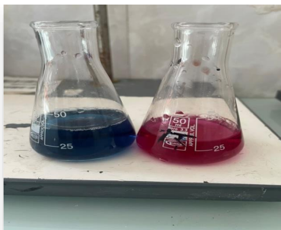
Figure III.21 : Dosage de la dureté totale
