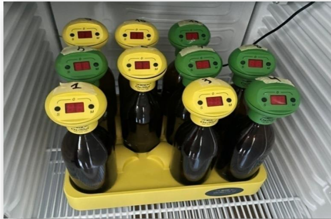
Figure III.28 : Mesure de la DBO 5
