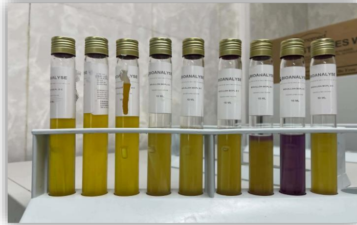
Figure III. 31 : Recherche de coliformes totaux en milieu liquide.
