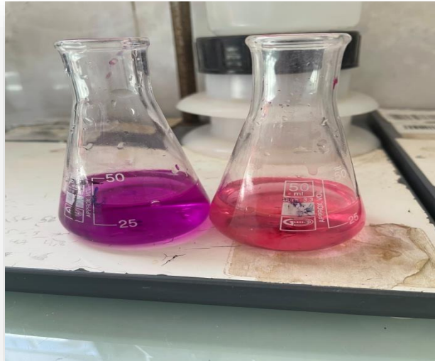
Figure III.22: Dosage de la dureté calcique.
