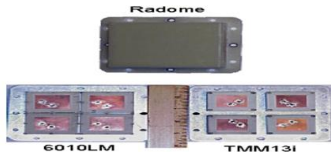
Figure.II. 17 : Image des matrices adaptatives à quatre éléments miniaturisées GPS utilisant un substrat 6010 LM (gauche) et un substrat TMM13i (à droite)
