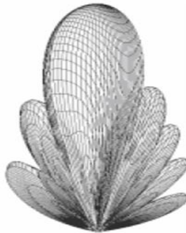
Figure.I. 2 : Exemple de diagramme de rayonnement 3D en valeurs logarithmiques
