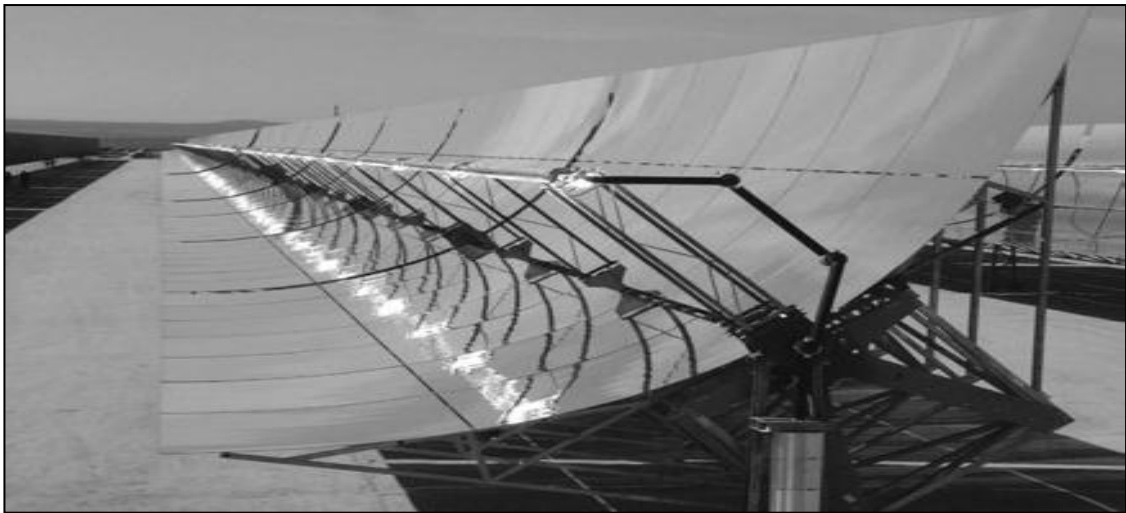
Figure (III.1). Miroirs et réflecteurs produisent les températures élevées requises par les processus industriels [24].
