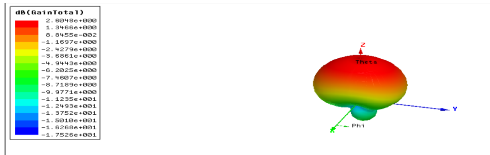
Figure III.9 :Diagramme de rayonnement 3D de l'antenne réalisée sur substrat FR4.
