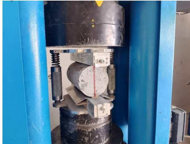
Figure II.29 : l'essai de traction par fendage
