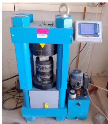
Figure II.28 : La machine pour essai de compression
