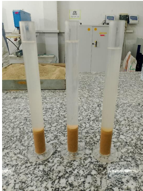
Figure II.10 : Équivalent de sable.
