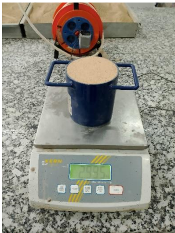
Figure II.11 : Mode opératoire de la masse volumique apparente de sable 0/5.
