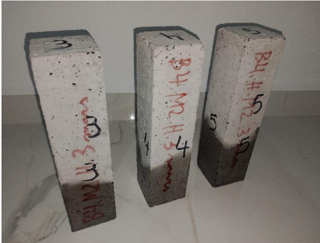
Figure II.34 : essai d'absorption capillaire
