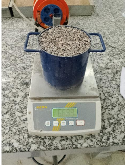
Figure II.12 : Mode opératoire de la masse volumique apparente de gravier 3/8.
