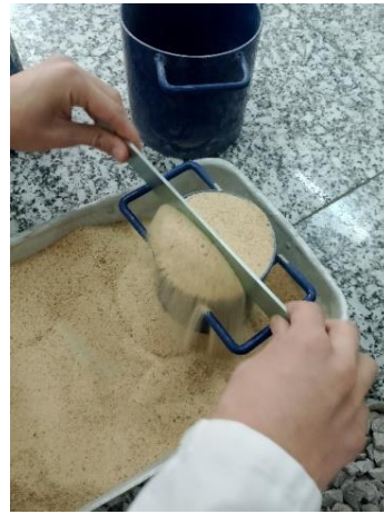
Figure II.11 : Mode opératoire de la masse volumique apparente de sable 0/5.
