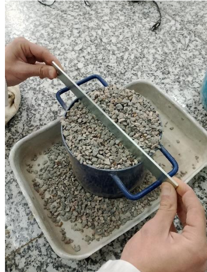
Figure II.12 : Mode opératoire de la masse volumique apparente de gravier 3/8.
