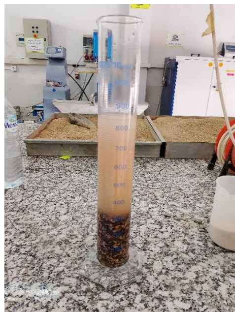
Figure II.17 : Mode opératoire de la masse volumique absolue de gravier 3/8.
