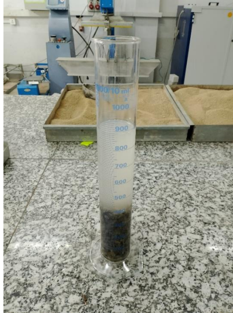
Figure II.18 : Mode opératoire de la masse volumique absolue de gravier 8/15.
