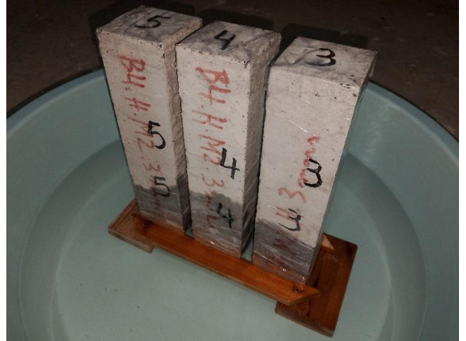
Figure II.34 : essai d'absorption capillaire
