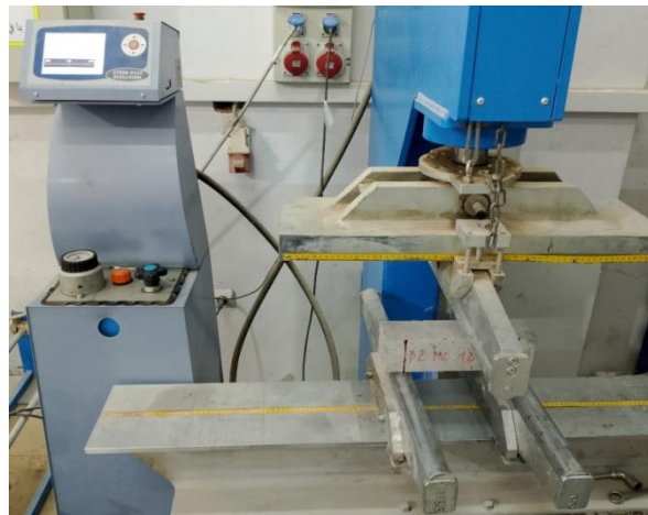
Figure II.30 : la machine de l'essai de traction par flexion.
