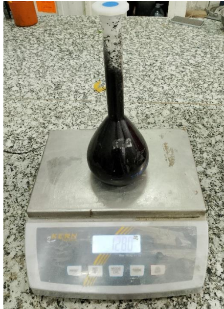
Figure II.19 : Mode opératoire de la masse volumique absolue de caoutchouc 0/5.
