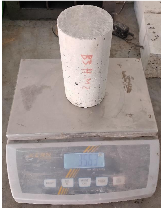
Figure II.27 : Mesure de la masse volumique des bétons à l'état durci.
