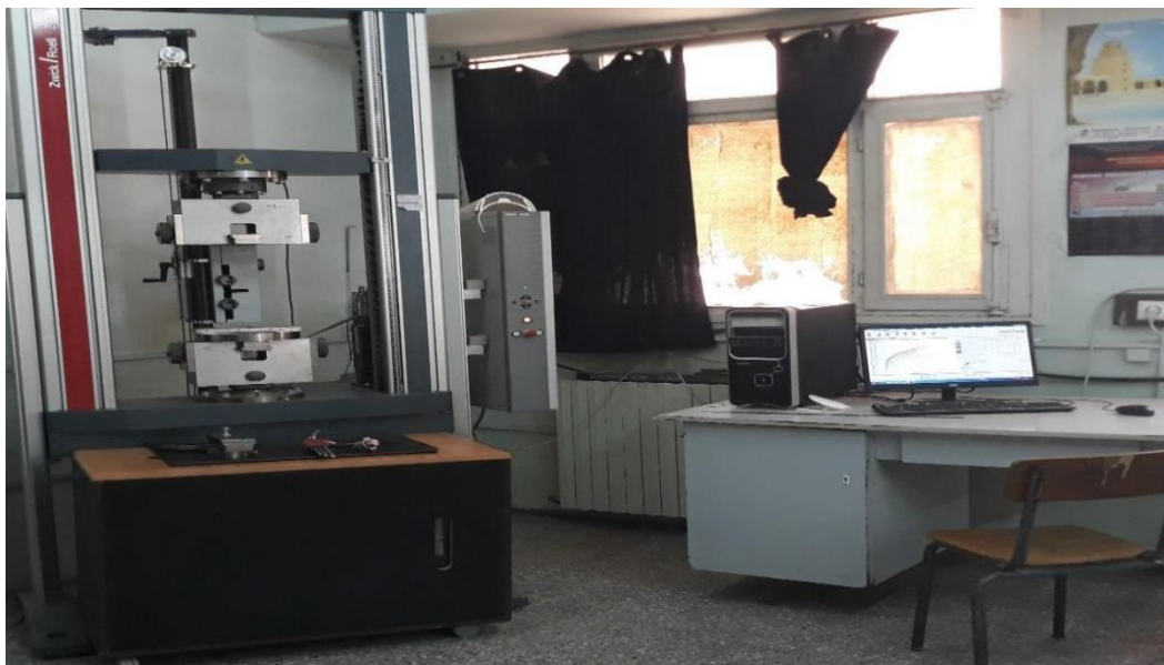
Figure 3.11 : Essai de flexion à quatre points (Zwick/Roell Z100)
