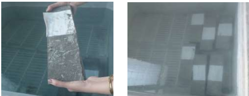
Figure III-23 Processus de cure humide et immersion du premier lot d'éprouvettes
