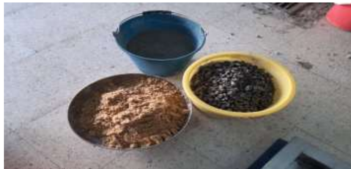
Figure III-14 Étape de préparation, pesage et dosage des constituants
