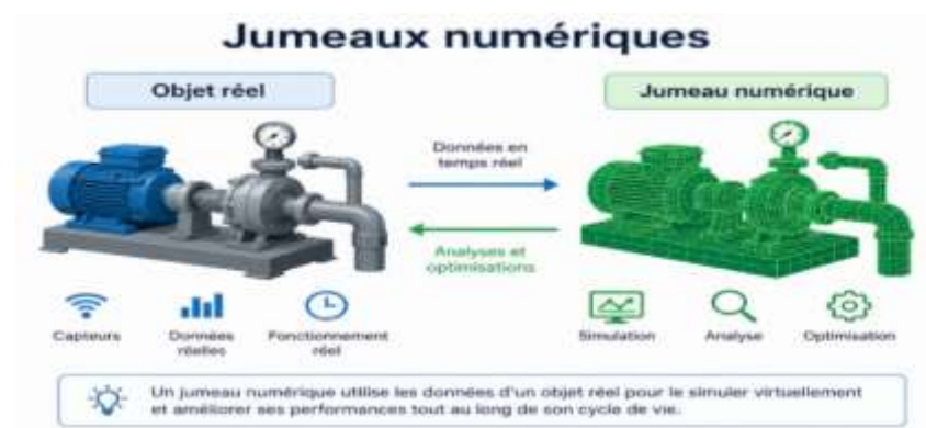
Figure II-9 Principe de fonctionnement d'un jumeau numérique
