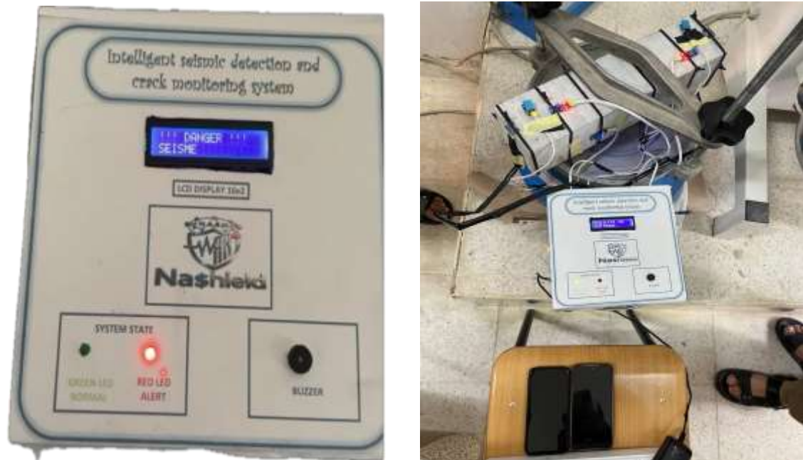
Figure III-35 Validation de la détection des vibrations sismiques
