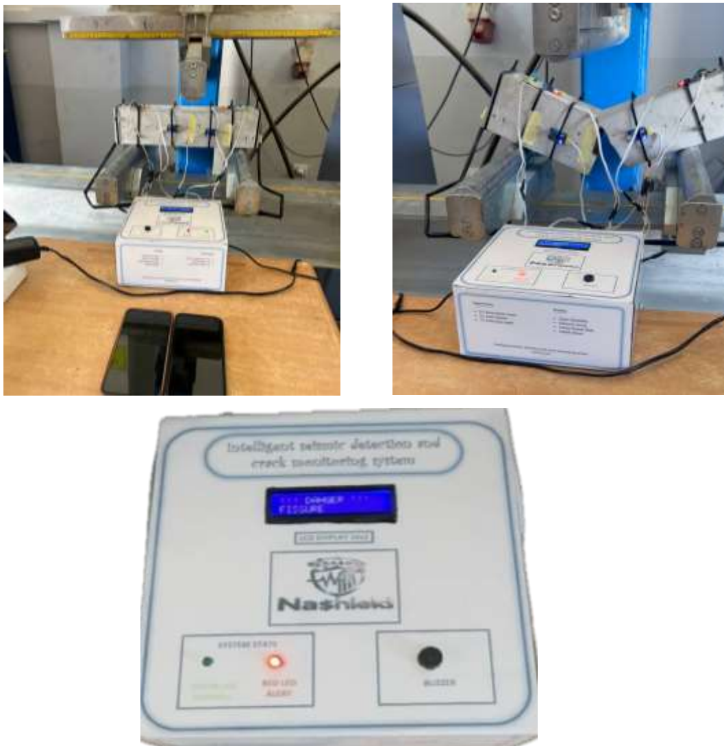
Figure III-37 Surveillance de la fissuration sous contrainte mécanique
