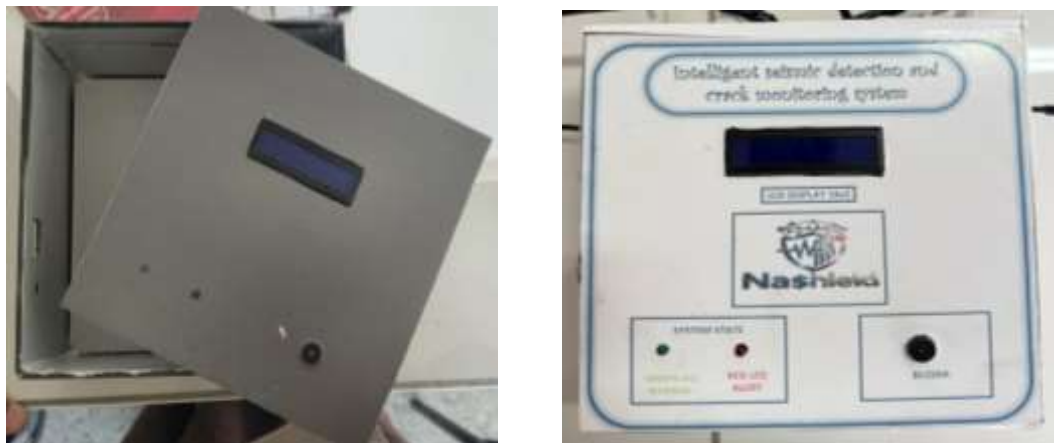
Figure III-34 Vue globale du boîtier de protection finalisé avec ses interfaces externes
