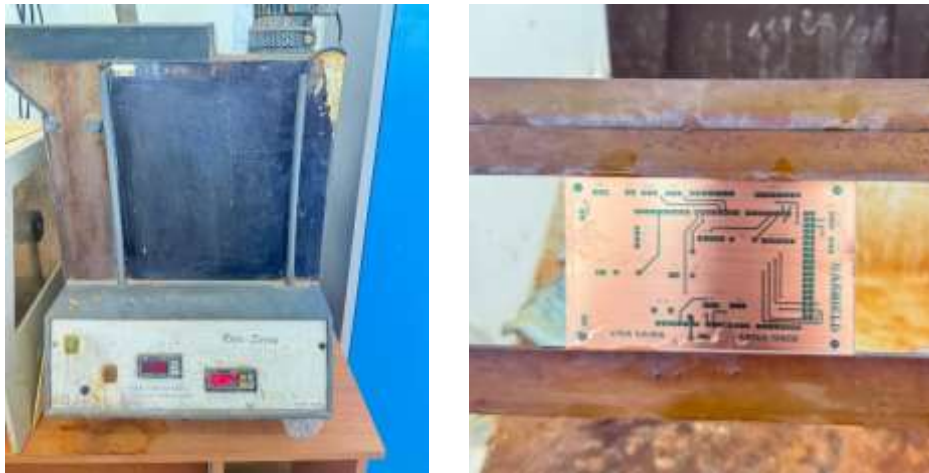
Figure III-30 Inspection visuelle des pistes de cuivre après l'étape de gravure chimique
