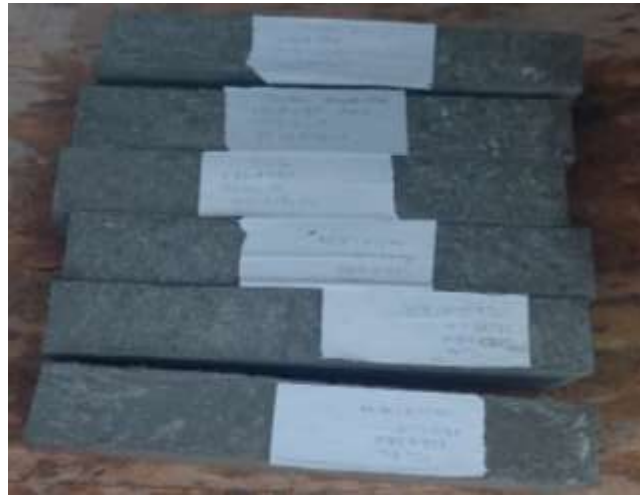
Figure III-24 Stockage à l'air libre (milieu sec) du second lot d'éprouvettes témoins
