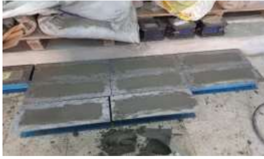
Figure III-21 Surfaçage, finition et cure des éprouvettes
