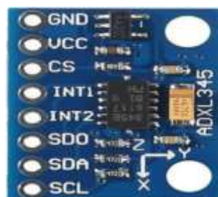
Figure II-1 Accéléromètre numérique ADXL345
