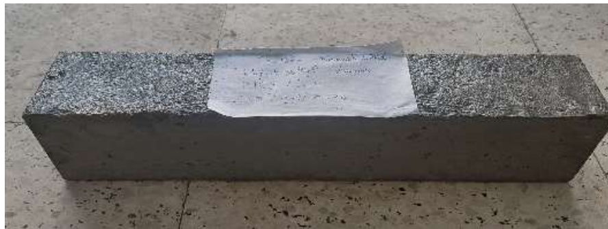
Figure III-22 Vue globale d'une mini-poutre en béton armé après décoffrage
