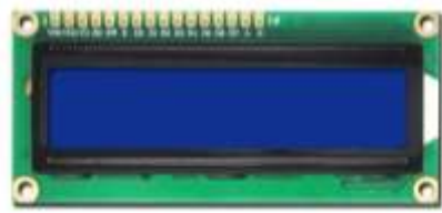
Figure III-11 L'Afficheur alphanumérique LCD 16x2
