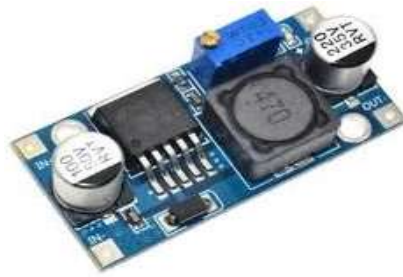
Figure III-8 Régulateur de tension Buck (LM2596).
