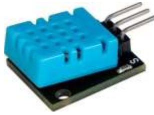
Figure III-4 Capteur numérique d'humidité et de température (DHT11).
