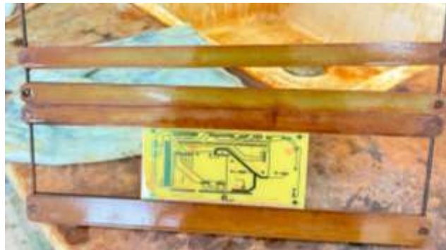
Figure III-31 Vue finale de la carte PCB "NASHIELD" nettoyée et prête pour le perçage
