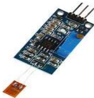
Figure II-15 Capteur jauge de contrainte BF350
