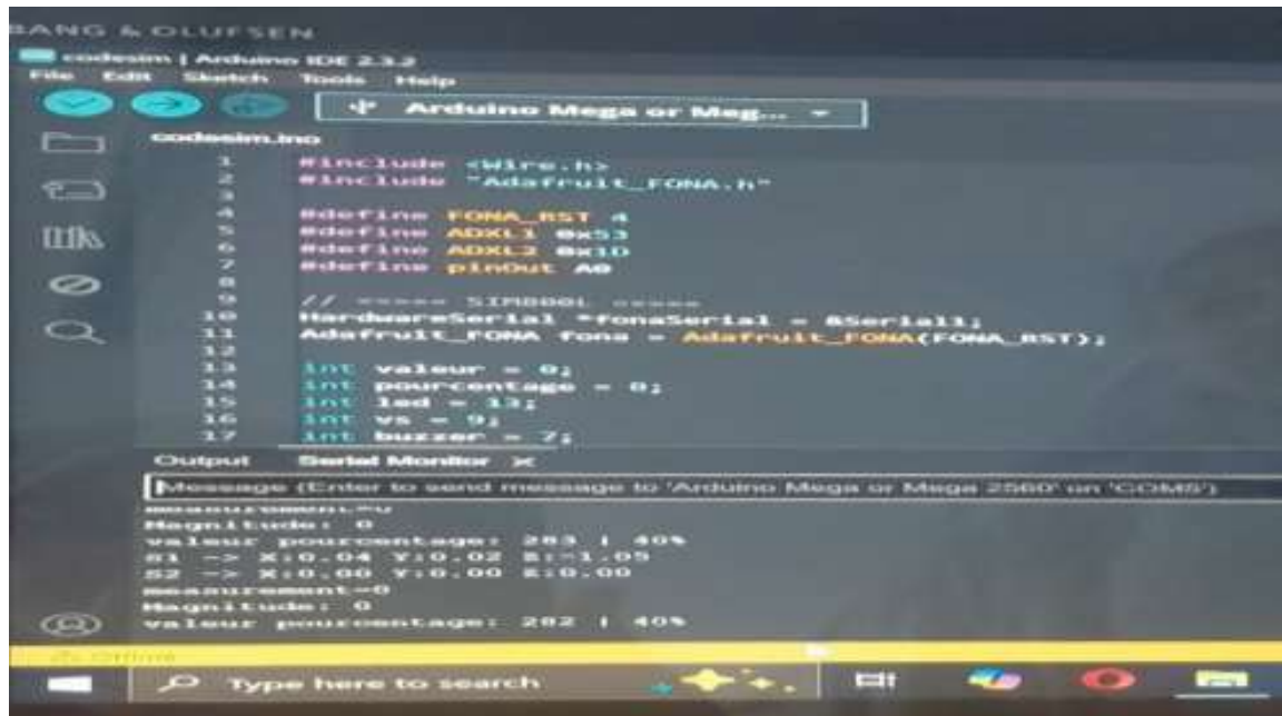
Figure III-40 : Affichage des données des capteurs ADXL sur le moniteur série.
