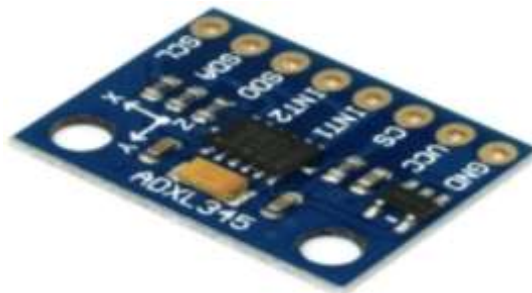
Figure II-14 Capteur d'accélération ADXL345
