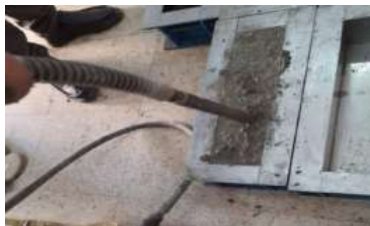
Figure III-20 Remplissage final et serrage par vibration mécanique
