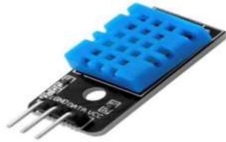
Figure II-12 Capteur d'humidité et de température DHT11
