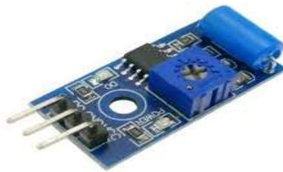
Figure III-3 Capteur de vibration piézo-mécanique (SW-420).
