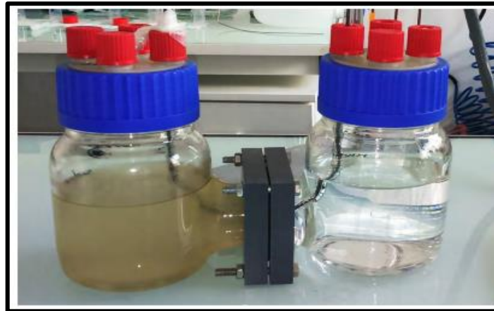
Figure.II.10. Dispositif à deux compartiments ou cellule « en H » [9]
