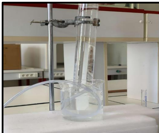
Figure.III.30 : Piège à hydrogène pour mesurer le débit.
