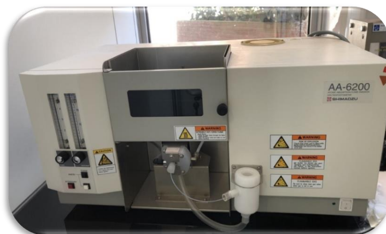
Figure II.10. Spectromètre à Absorption atomique, Shimadzu AA 6200.
