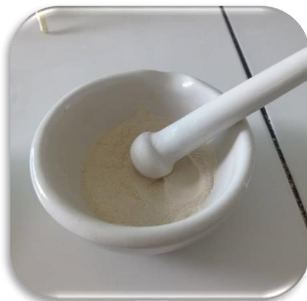
Figure II.5. Broyage manuel de la gomme arabique.
