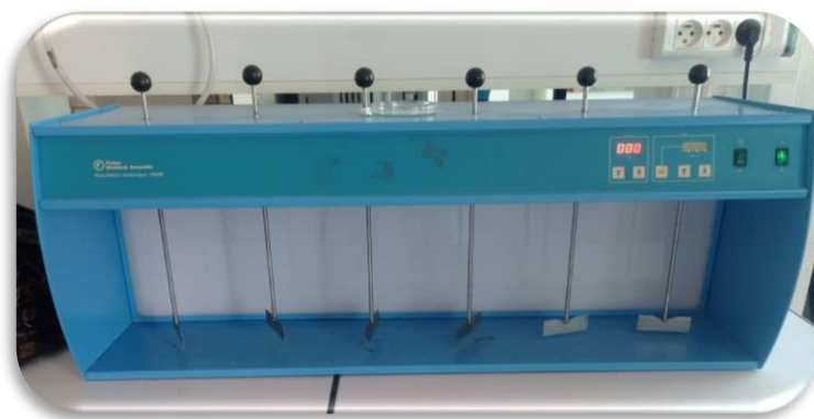
Figure II.7. Flocculateur de laboratoire utilisé pour les essais de coagulation-floculation.
