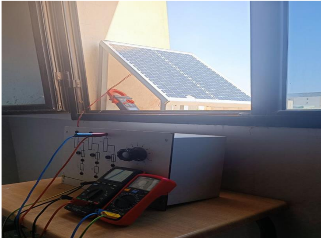
Figure III.7 : Étude expérimentale des caractéristiques électriques d'un module solaire photovoltaïque
