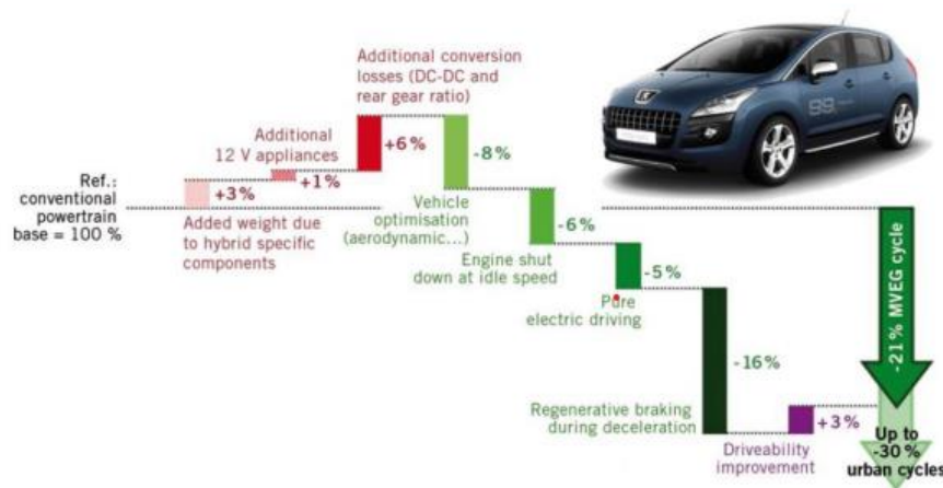
Figure 1.5 : Détail des gains apportés par l'hybridation full-Hybrid sur la Peugeot 3008[9].
