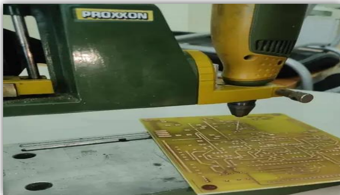
Figure 3.16 : Perçage de la carte.
