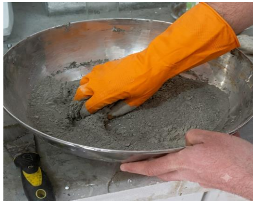
Figure 23: Malaxage à sec du sable et du ciment
