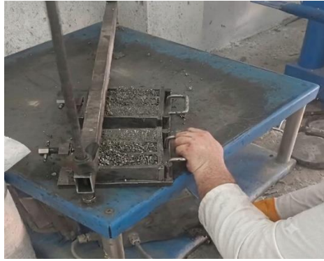
Figure 27: Vibration et compactage des éprouvettes
