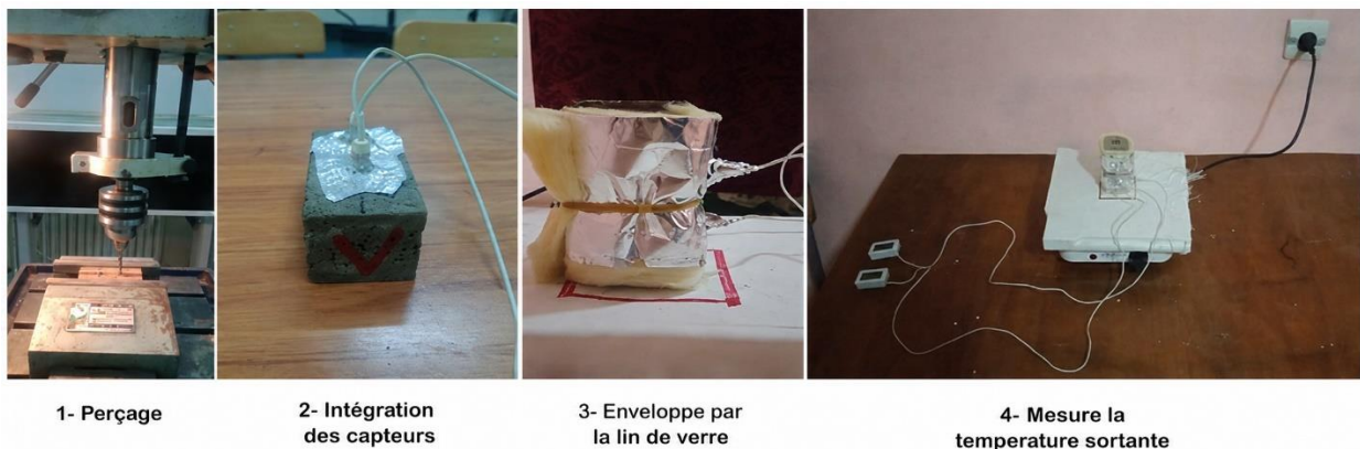
Figure 30 : Processus de la conductivité thermique .
