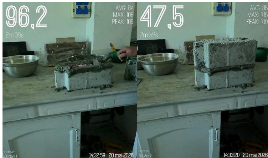
Figure37: Test d’isolation acoustique brique léger
