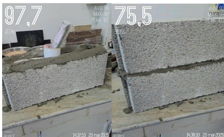
Figure 36: Test d'isolation acoustique brique conventionnel
