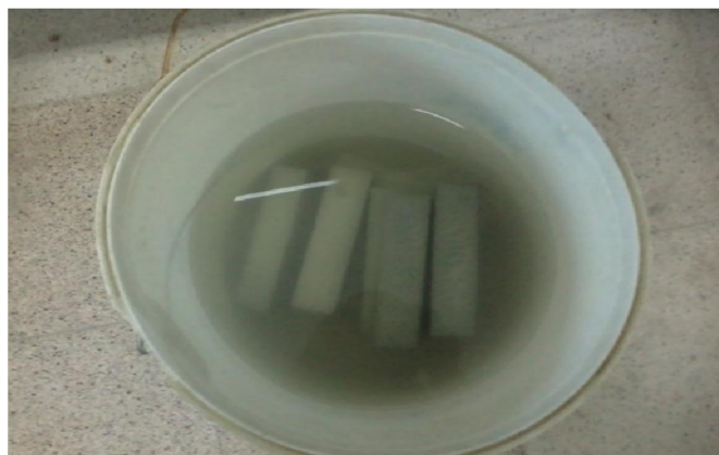
Photo (II.1): Mode de conservation des éprouvettes.
