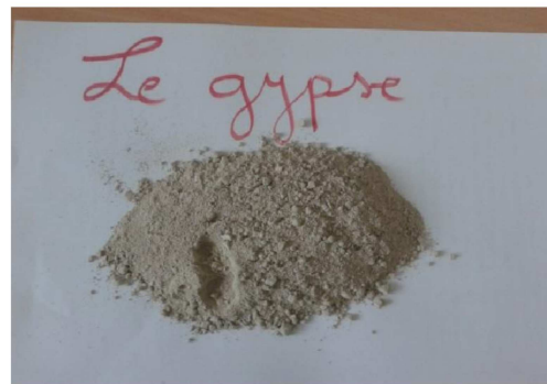
Photo (I.7) : le gypse après broyage
