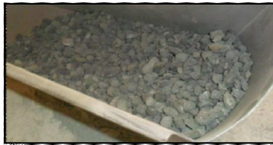
Figure(I.3) : Concassage de clinker [7].
