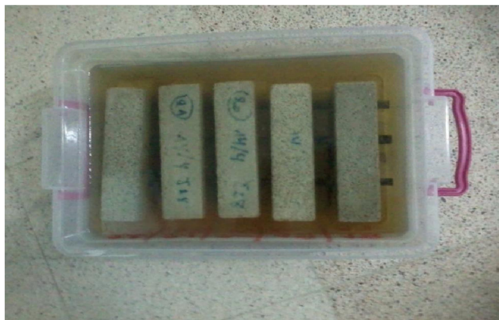
Photo (II.4): Eprouvettes de mortiers immergés dans la solution acide
