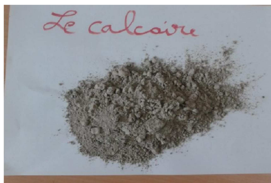
Photo(III.1) : calcaire après le broyage
