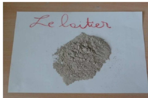
Photo(III.4) : laitier après le broyage
