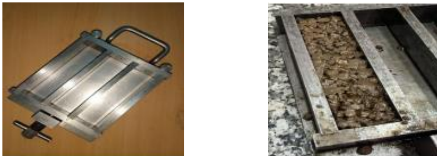
Figure 34 : moule (4*4*16) rempli d'un échantillon de géopolymère.
