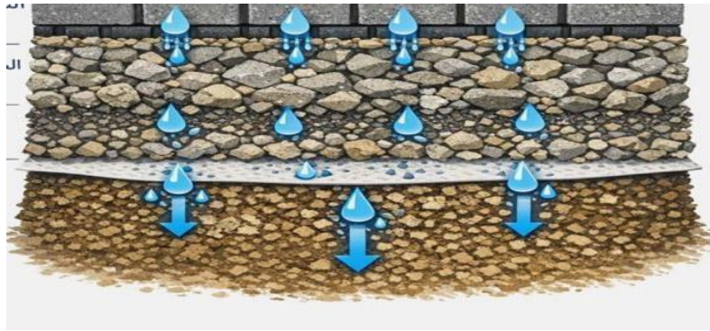
Figure 13 : photo represente les couches de drainage.
