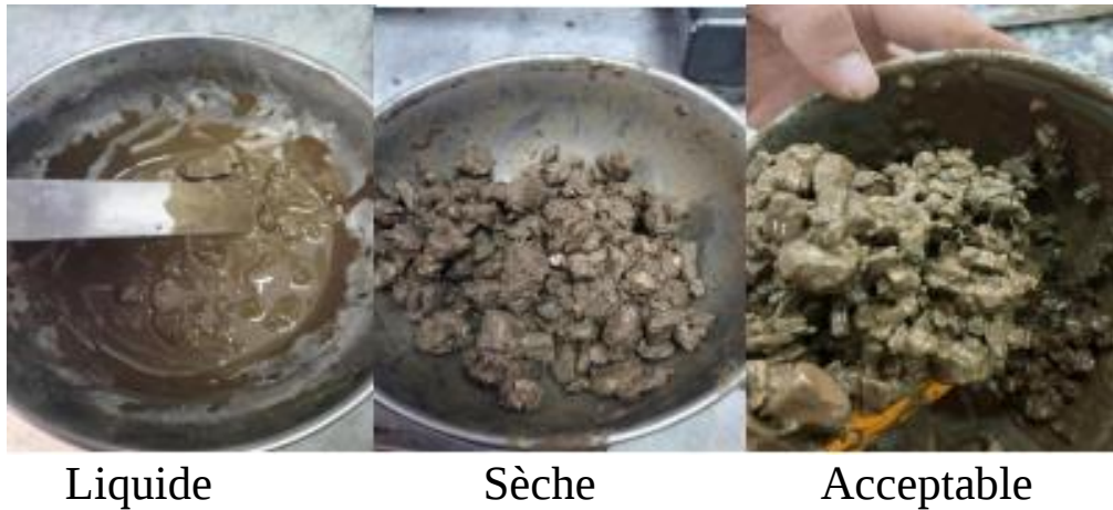
Figure 33 : Différents états du mélange géopolymérique.
