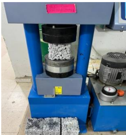
Figure 39: résistance à compression ciment
