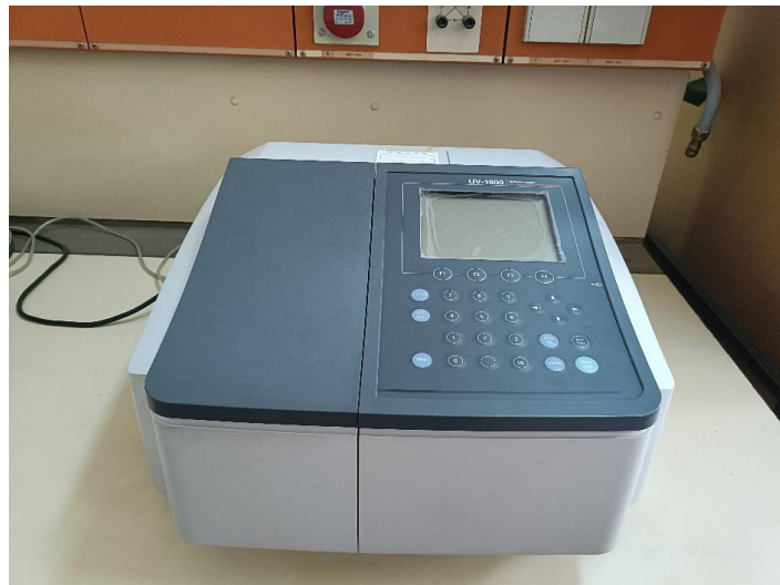
Figure IV.8 spectrophotomètre utilisé pour la détermination de la transmittance
