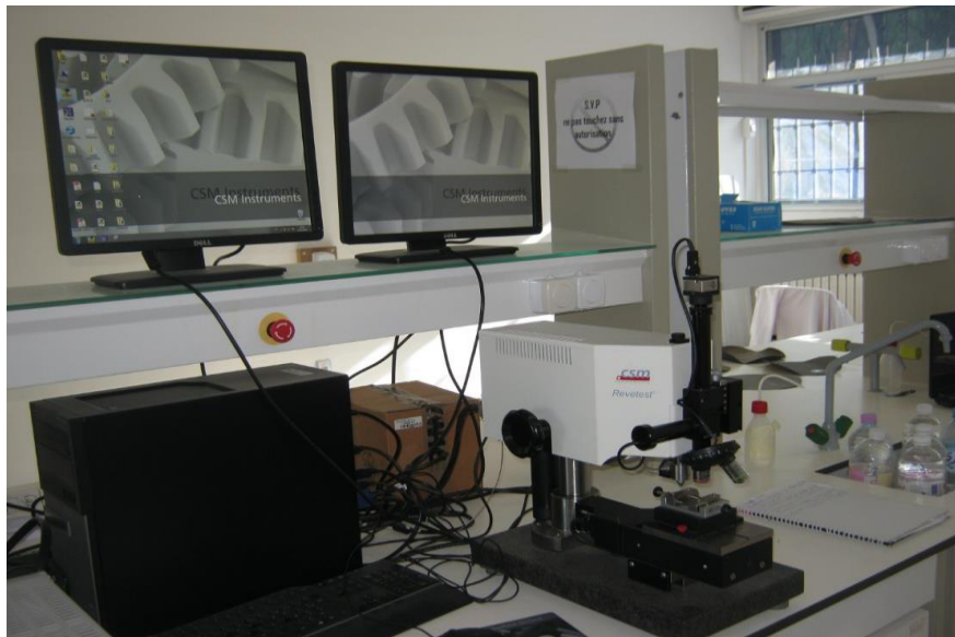
Fig. IV.10 Dispositif d'essai de rayage CSM
