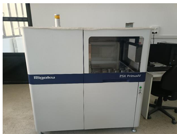
Figure IV.1 Spectromètre de fluorescence X de type ZSX Primus IV
