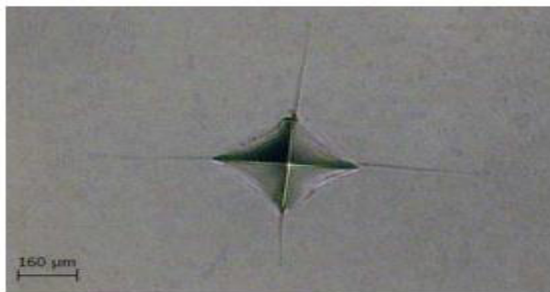
Figure I.13 : Fissuration schématique de type Vickers [50]
