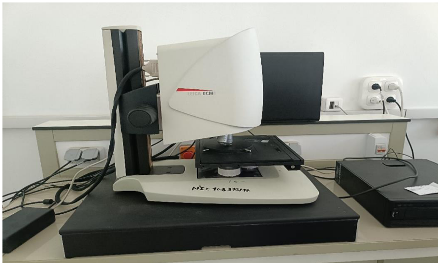
Figure IV.6 Microscope con-focal utilisé
