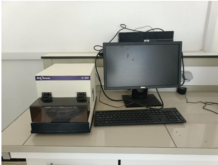
Figure IV.7 Profilomètre à stylet Alpha Step D 500
