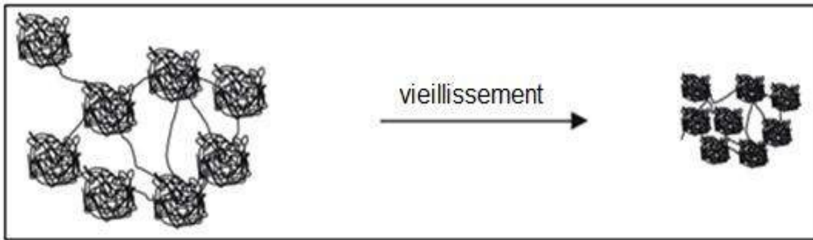
Figure II.8 : Gels obtenus à partir de tétralcxydes de silicium par catalyse basique [98]
