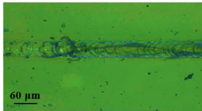
Figure V.10 Observation optique du délaminage de la matière sur un verre (SC), (écaillage et arrachement en régime micro-abrasif).
