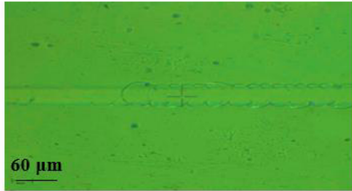
Figure V.9 Observation optique des premiers groupes de fissures sur un verre (SC) (Fissures circulaires et radiales en régime fragile).
