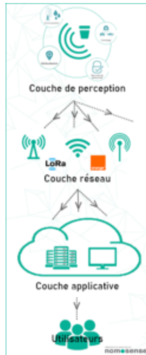
FIGURE 1.2 – Architecture du réseau IoT
