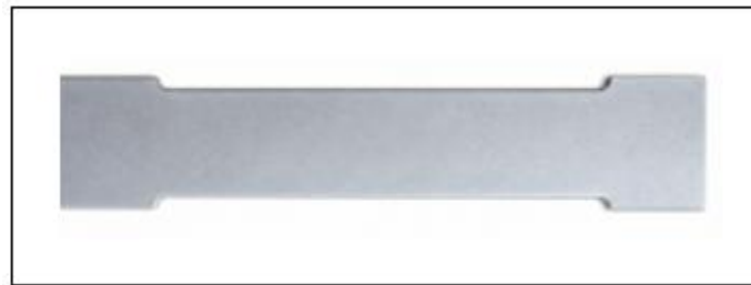
Figure 19. Eprouvettes après recuit à 250 °C pendant 45 min
