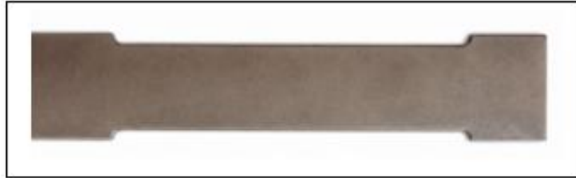
Figure 37. Éprouvettes après recuit à 250 °C pendant 45 min
