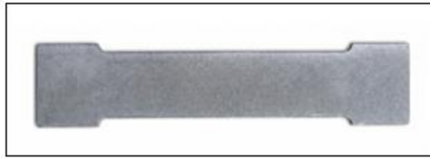
Figure 21. Eprouvettes après recuit à 450 °C pendant 15 min
