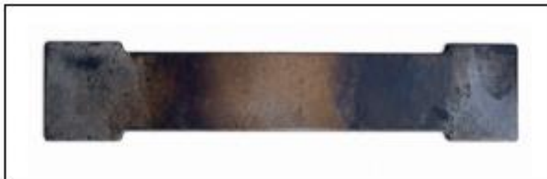
Figure 41. Éprouvettes après recuit à 450 °C pendant 30 min.
