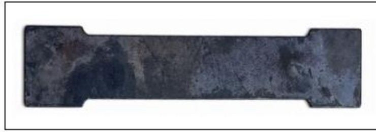
Figure 43. Éprouvettes après recuit à 450 °C pendant 45 min.
