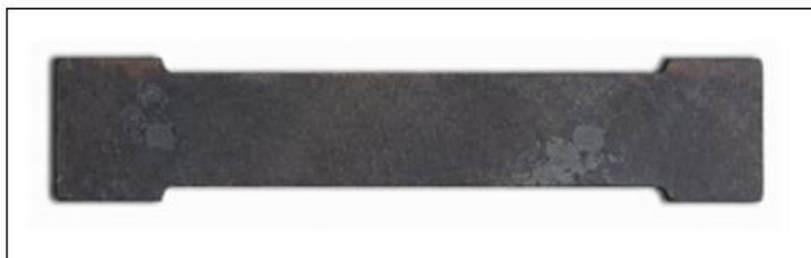
Figure 27. Eprouvettes après recuit à 690 °C pendant 15 min
