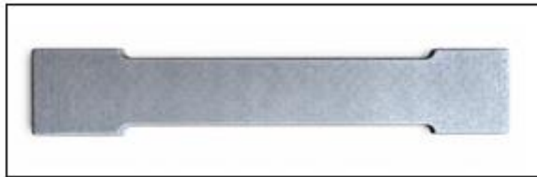
Figure 17. Eprouvettes après recuit à 250 °C pendant 30 min
