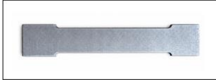
Figure 15. Eprouvettes après recuit à 250 °C pendant 15 min
