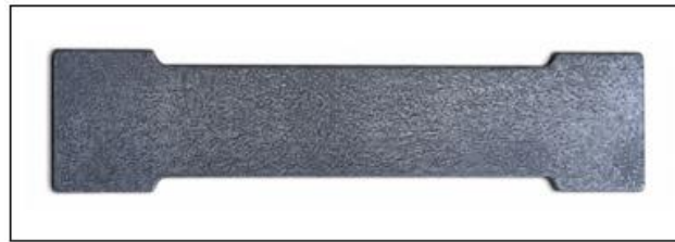
Figure 25. Eprouvettes après recuit à 450 °C pendant 45 min
