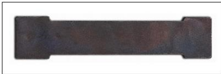
Figure 31. Éprouvettes après recuit à 690 °C pendant 45 min
