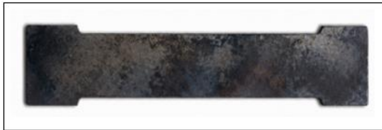
Figure 45. Éprouvettes après recuit à 690 °C pendant 15 min.
