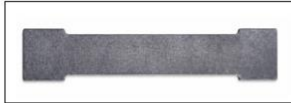
Figure 23. Eprouvettes après recuit à 450 °C pendant 30 min
