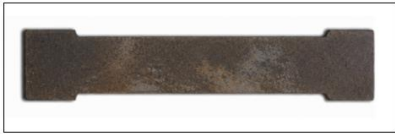
Figure 29. Eprouvettes après recuit à 690 °C pendant 30 min
