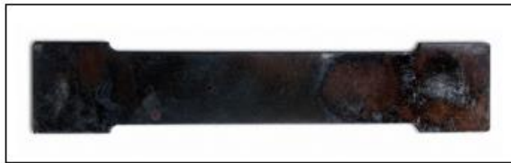
Figure 39. Éprouvettes après recuit à 450 °C pendant 15 min.
