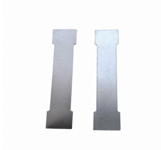
Figure 10. Comparaison des éprouvettes métalliques : DC06 (à droite) et DX53D+Z (à gauche)
