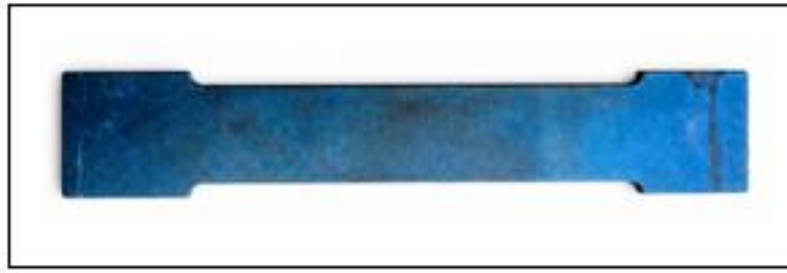
Figure 35. Éprouvettes après recuit à 250 °C pendant 30 min
