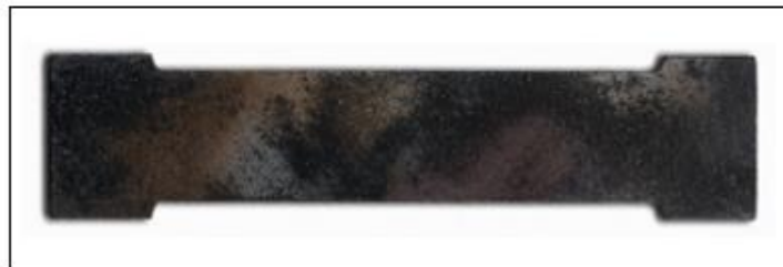
Figure 47. Éprouvettes après recuit à 690 °C pendant 30 min.
