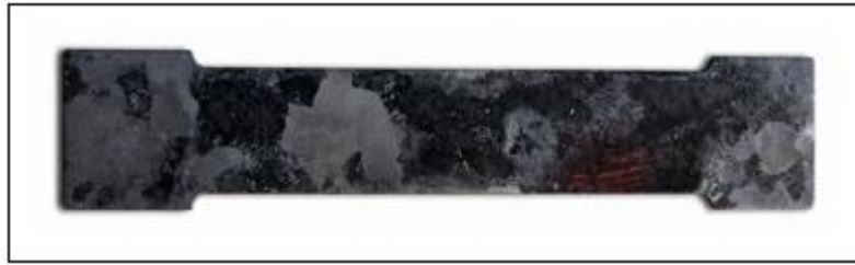
Figure 49. Éprouvettes après recuit à 690 °C pendant 45 min.
