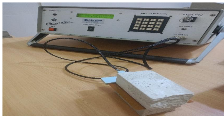
Figure II.21: essais de Conductivité thermique.
