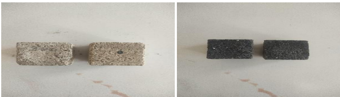
Figure 16: Présentation des éprouvettes fabriquées par liège après exposition à la température élevée.
