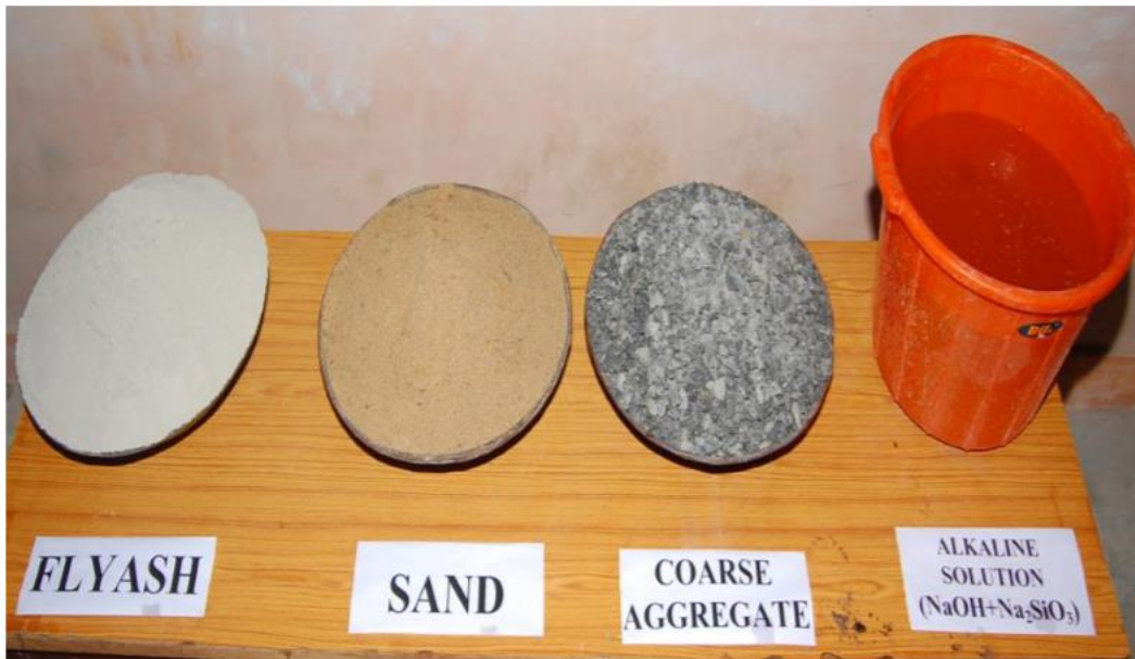
Figure I.1: Constituant du béton géopolymère [10].
