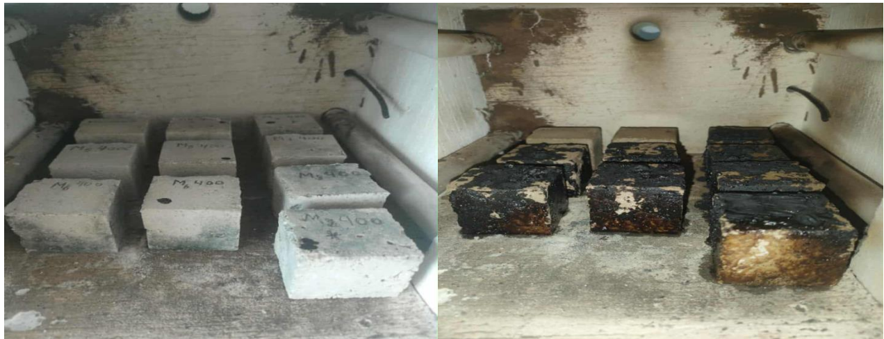
Figure II.22 : éprouvettes du béton géopolymère avant et après exposition à haute température.
