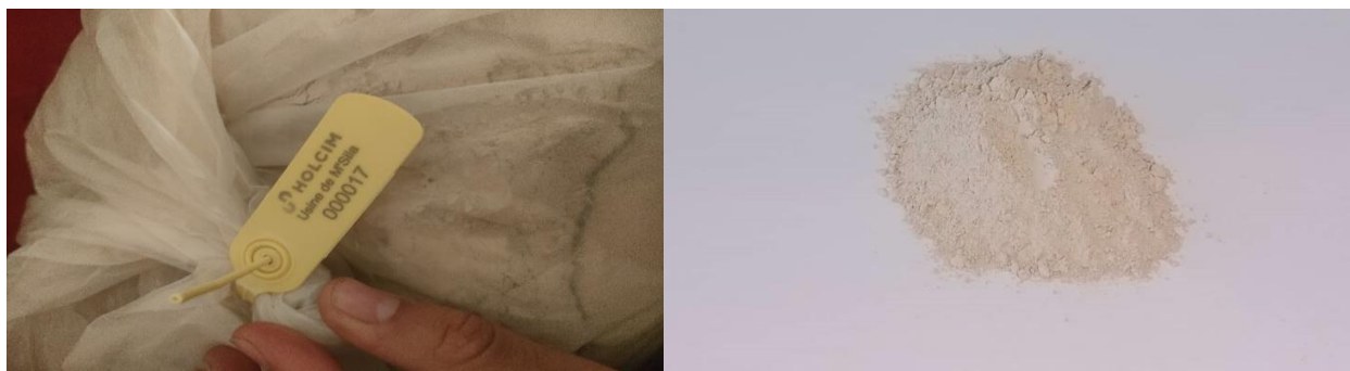
Figure II.1: Laitier de haut fourneau (Lafarge à Hammam Dalaa - M'sila).
