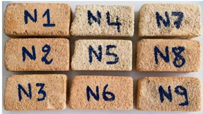
Figure III.6: Aspect visuel des éprouvettes contenant du filler calcaire (F) et du métakaolin (K) après 30 jours d'exposition à une solution d'acide sulfurique à 3,5%.
