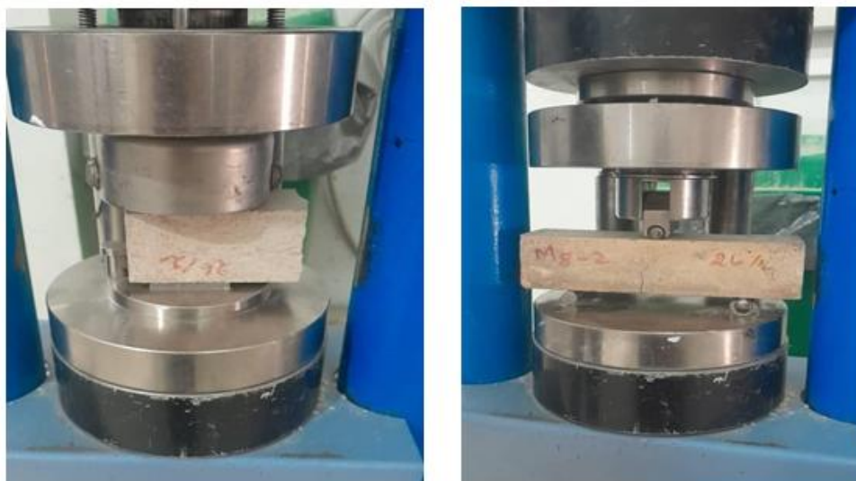
Figure II.9: L'essai des résistances à la compression et à la flexion
