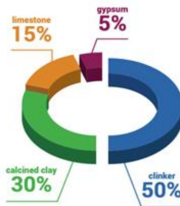
Figure I.11 : Différents constituants du ciment LC 3 . [37]
