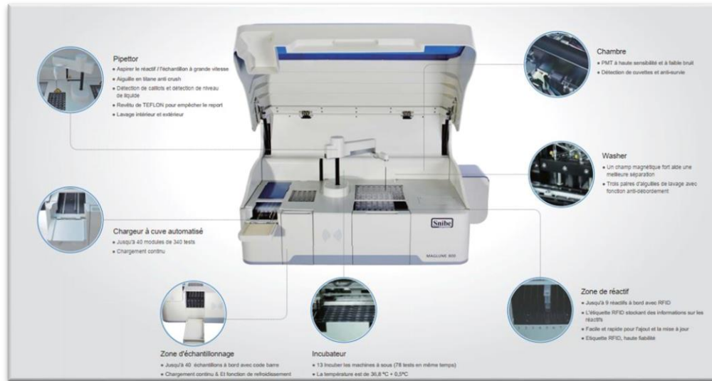
Figure 8 : Les composants de l'appareil Maglumi 800 (Snibe Diagnostic, 2018).
