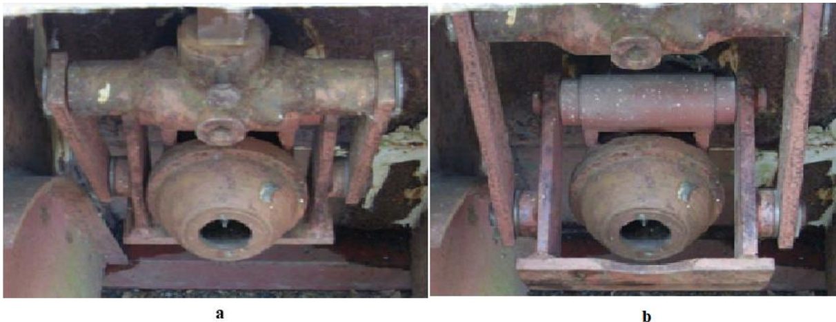
Figure. I.5. Déflecteur, a) Déflecteur passif, b) Déflecteur activé.
