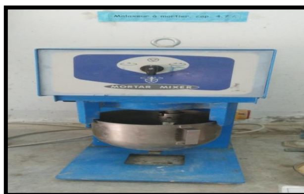
Figure II.6 : malaxeur normalisé EN 196-1.
