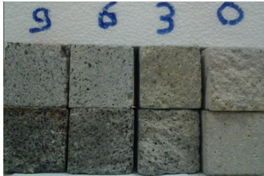
Figure.I.10. Vue des demi-spécimens exposés aux quatre cycles de chauffage-refroidissement à la température ambiante (20°C) et à la température 400°C [19].
