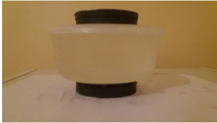
Figure II.5. Procédure de magnétisation de l'eau de gâchage.
