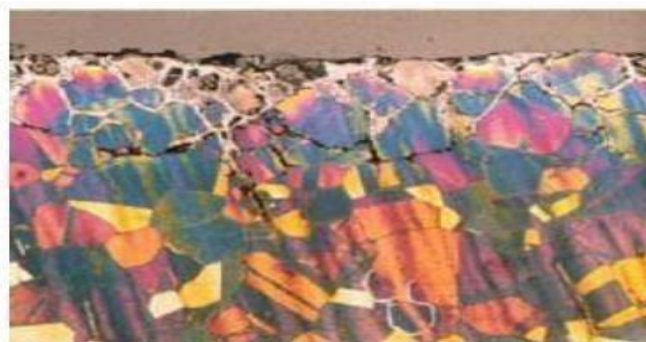
Figure I-9 : Corrosion intergranulaire d'un inox par HCl.
