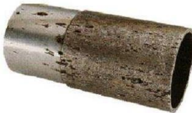
Figure I-7 : Corrosion par piqûres d'un acier inoxydable.
