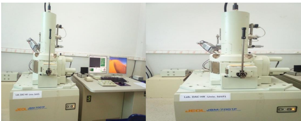
Figure II.22: Photo d'un microscope électronique à balayage de type JEOL (JSM.7001F).
