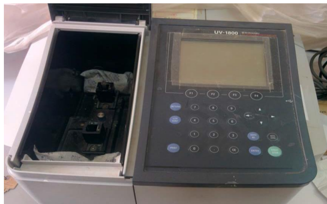
Figure II.25: Dispositif expérimental de la spectroscopie UV-visible utilisé de type UV-1800 (Université de Ferhat Abbas Sétif-1).
