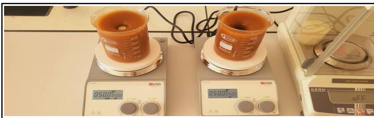
Figure 3.3: extraction des sucres par l'acide sulfurique
