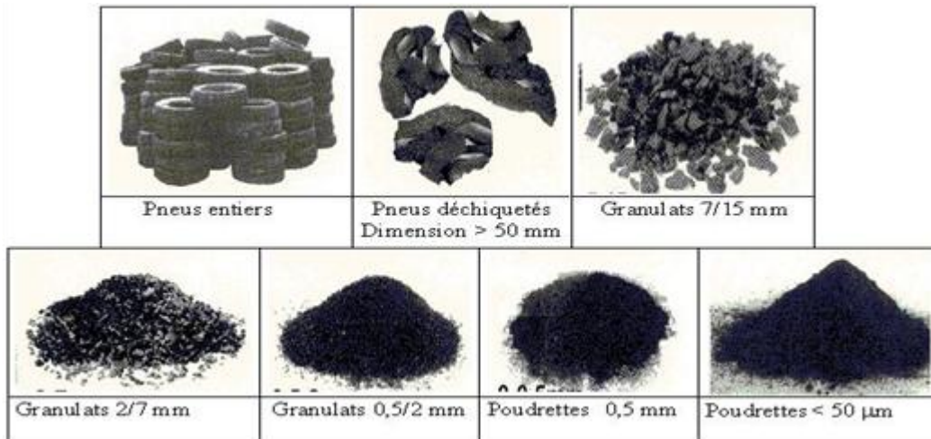
Figure I.4: Différents demi-produits issus du broyage des pneus usagés [1].
