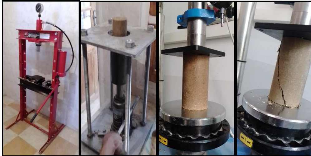
FIGURE III. 14 Mode opératoire – Essai UCS
