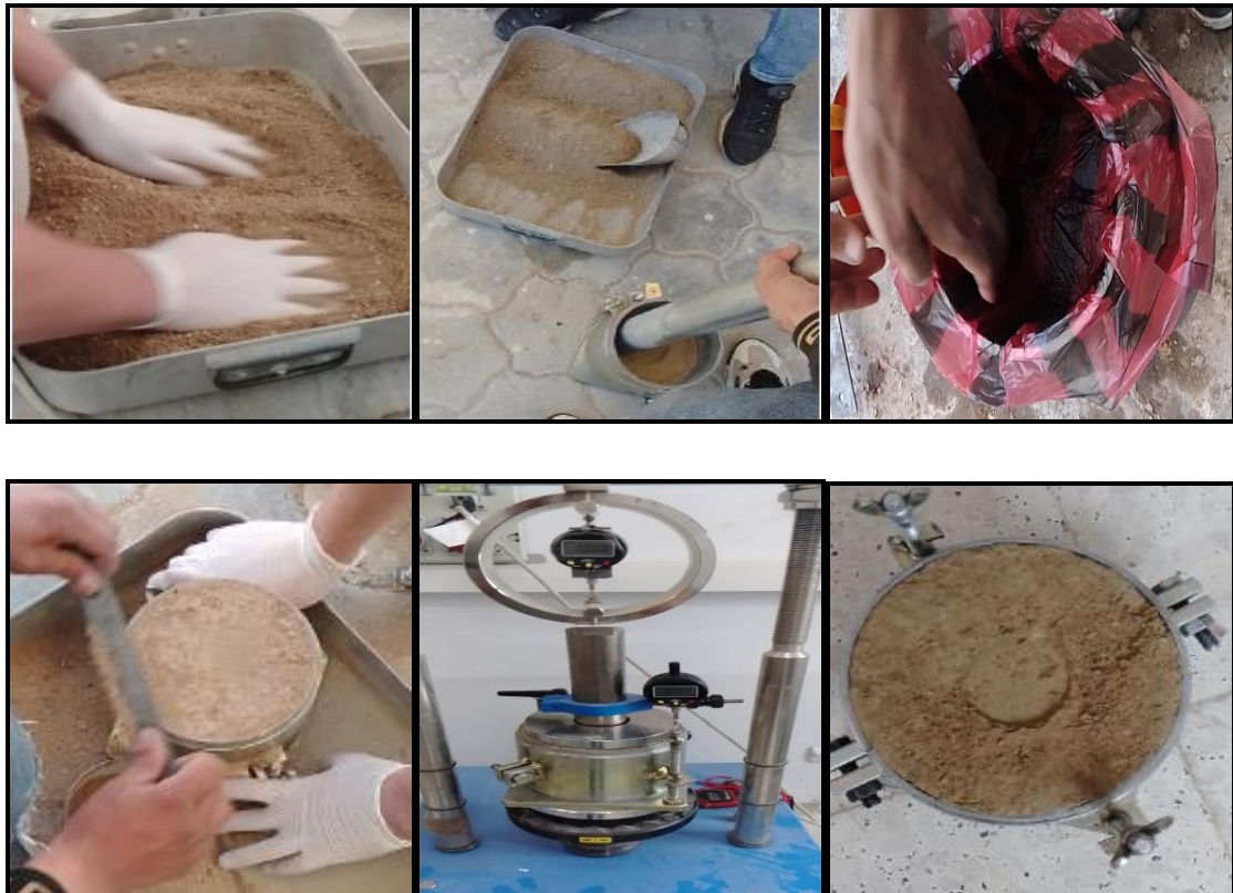
FIGURE III. 13 Déroulement de l'essai CBR.
