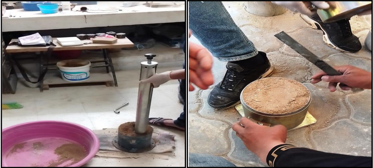
FIGURE III. 7 Principe de l'essai Proctor modifié.
