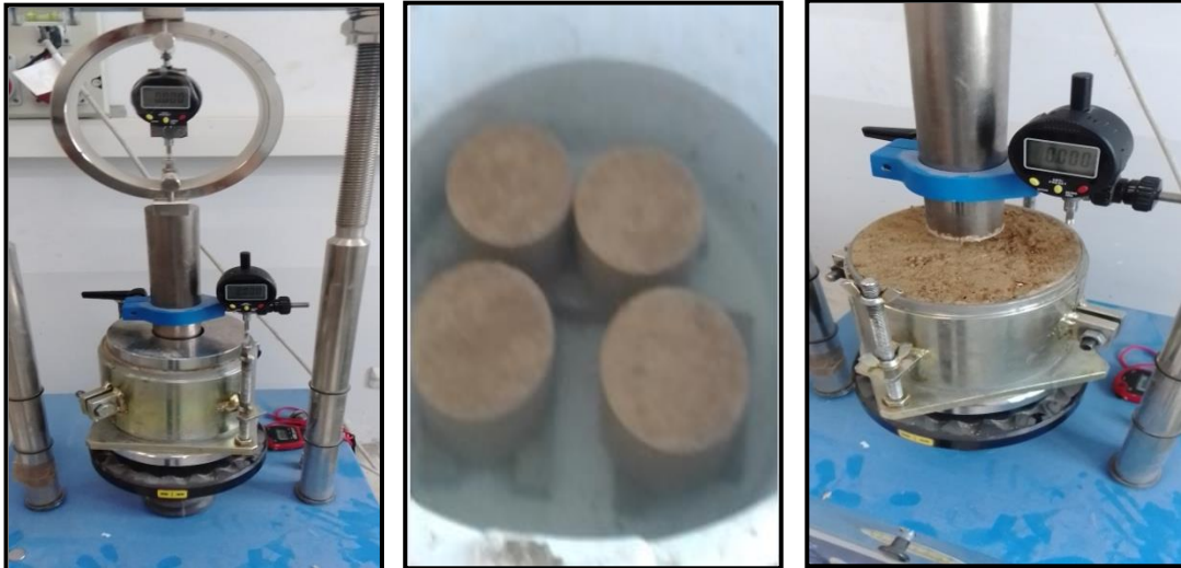
FIGURE III. 12 CBR du sol traité en ciment et déchets de cramique à l'Etat immergée (à la cure)
