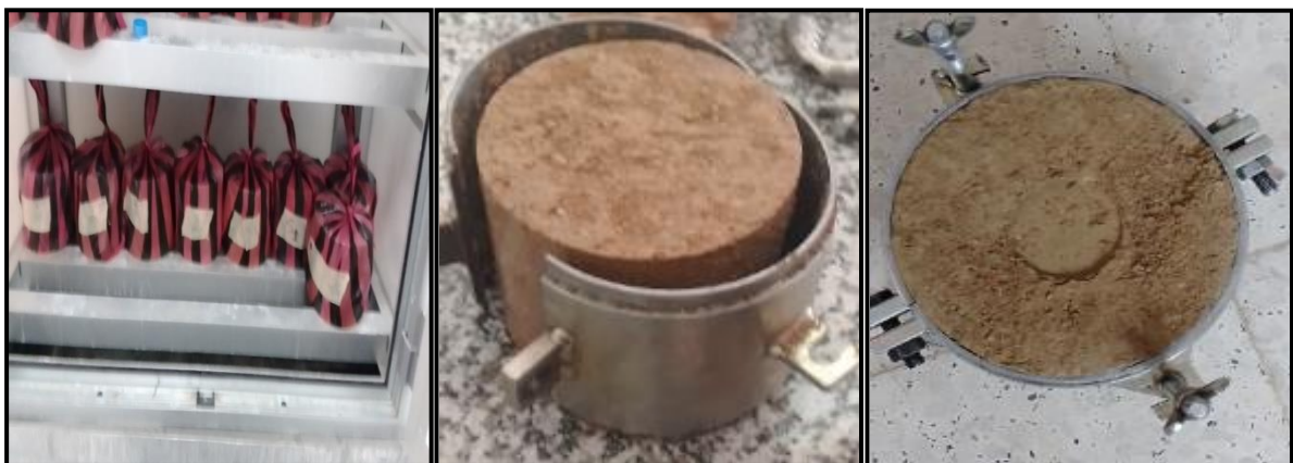
FIGURE III. 11 CBR du sol traité en ciment et déchet de cramique au temps de cure jours (1j, 28j).
