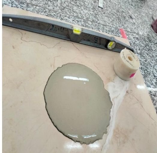
Figure. III.4. Détermination du point de saturation au mini cône (laboratoire de génie civil)
