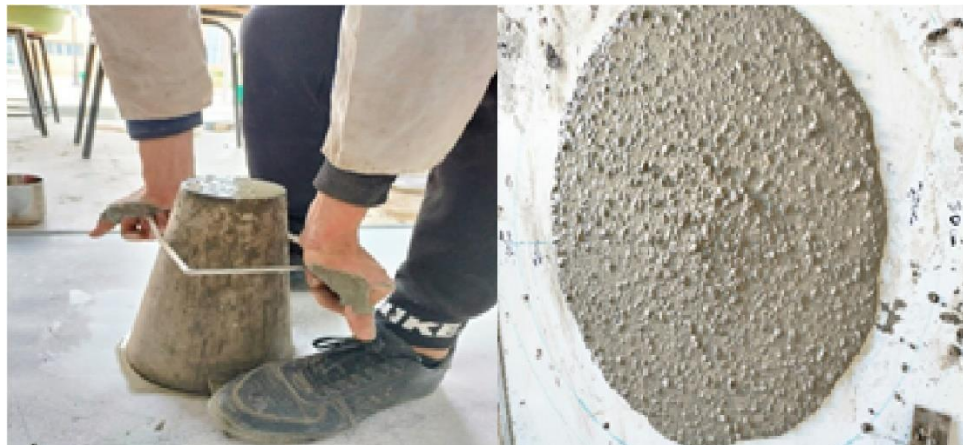
Figure II.1. Essai d'étalement (laboratoire de génie civil)
