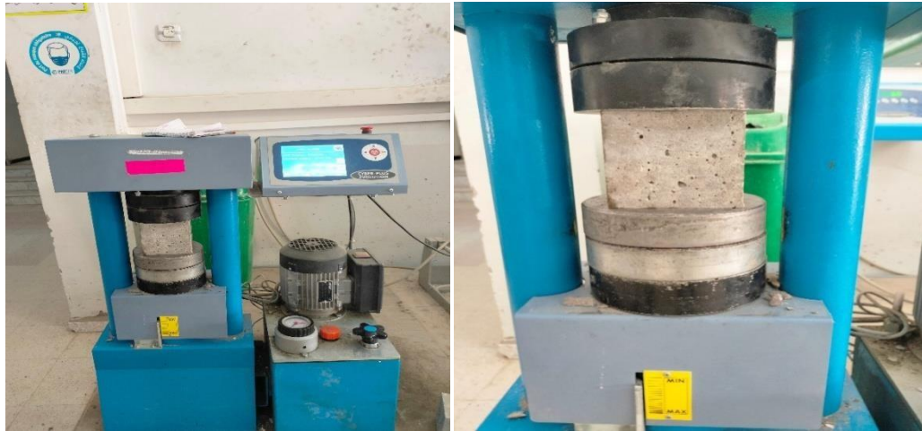
Figure II.5. L'essai de résistance à la compression (laboratoire de génie civil)
