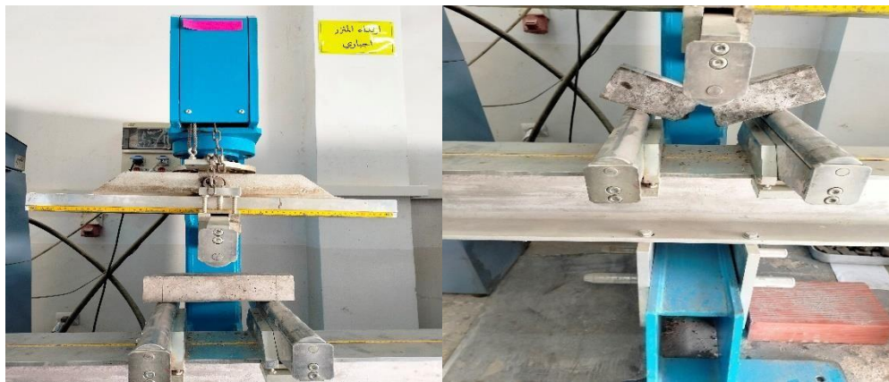
Figure II.6. L'essai de résistance à la flexion (laboratoire de génie civil)
