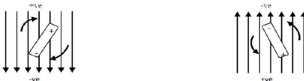
Figure 03: Mouvement d'un dipôle dans un champ électrique (Singh et Heldman, 2001)
