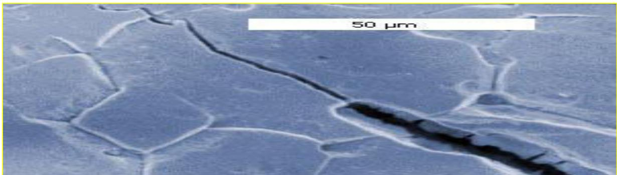
**Figure I. 6** : Corrosion sous contrainte.
