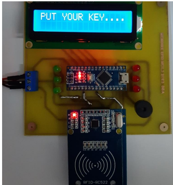
Figure 3. 9 : Premier test de notre carte électronique
