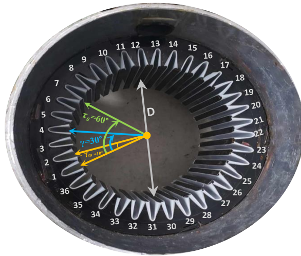
Fig.II.10: Différents angles entre les deux étoiles du MASDE
