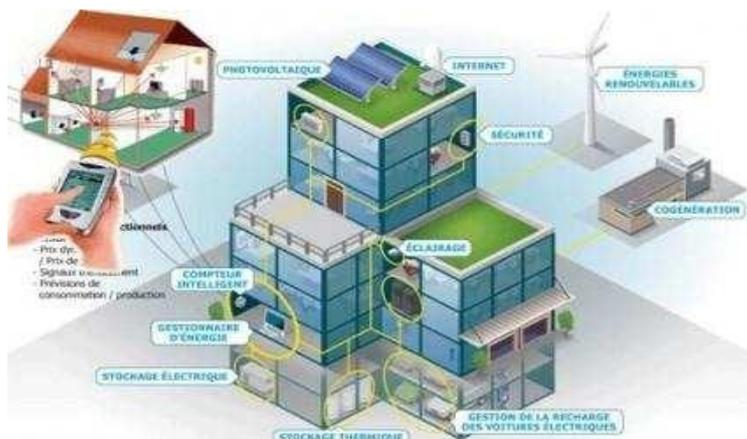
Figure I.6. Les éléments d'un bâtiment intelligent
