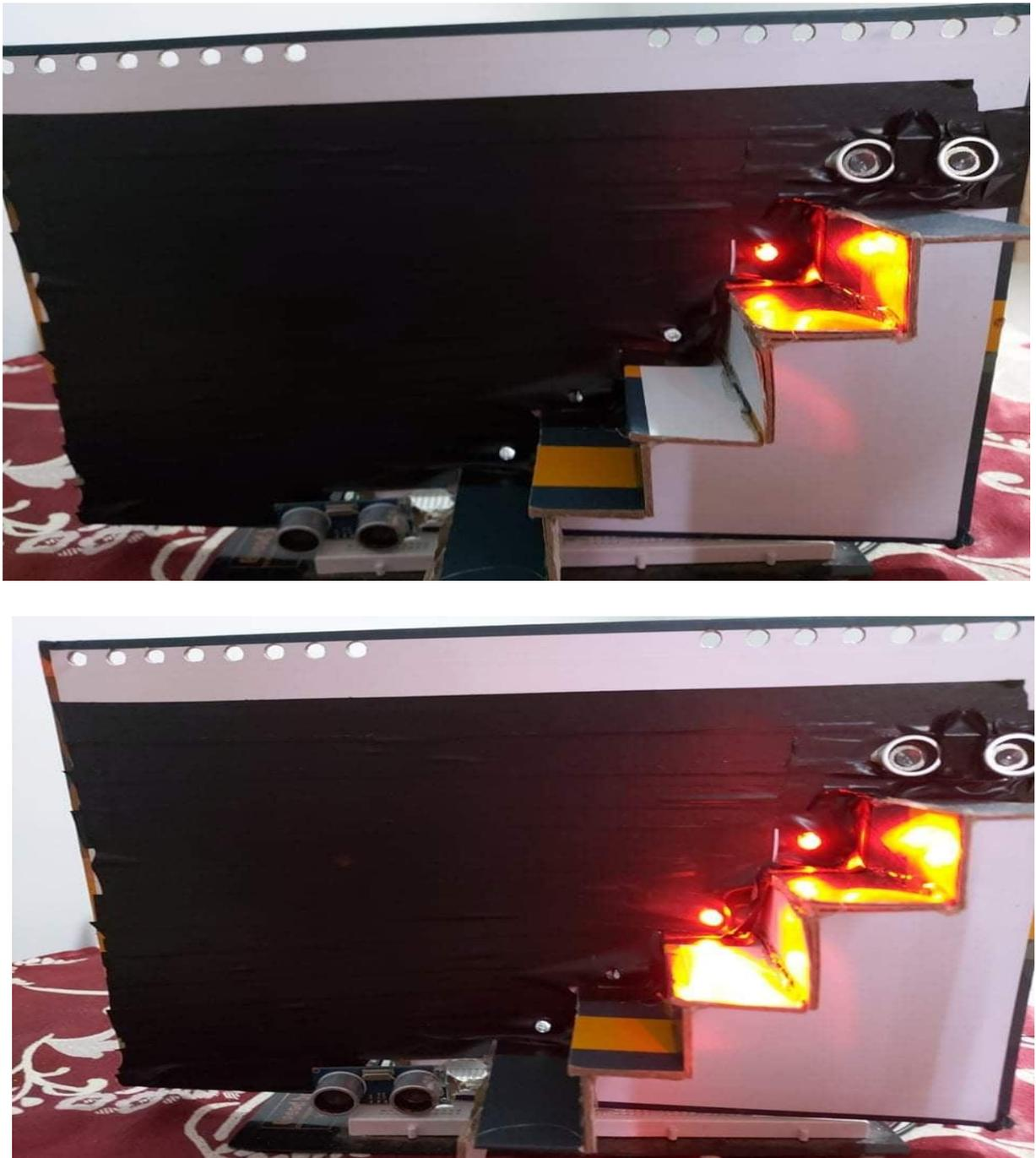
**Figure 3.18 : Visualisation de face de notre projet complète de l'éclairage progressive des marches des escaliers.**
