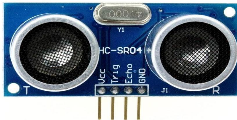
Figure 2.4 : Capteur ultrasonique
