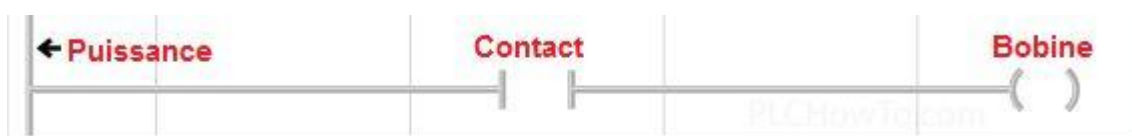
Figure I-15 : Principe du langage à contacts.
