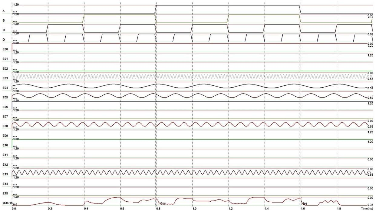
Figure 3.30: résultat de simulation d'un multiplexeur 4 : 16.
