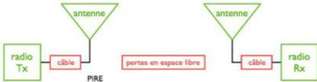
Figure I.2 Principe d'émission-réception
